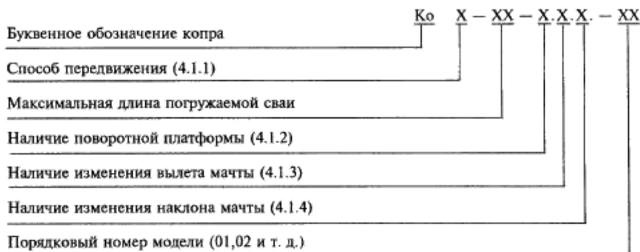
Пример условного обозначения копра на гусеничном ходу для забивки свай длиной до 14 м, с поворотной платформой, без изменения вылета и наклона мачты, второй модели:
