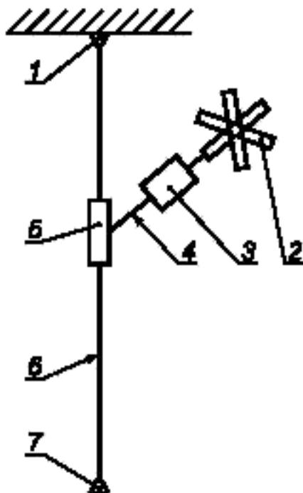
1 — анкерная точка опоры; 2 — страховочная привязь; 3 — амортизатор, 4 — строп, 5 — средство защиты ползункового типа;
