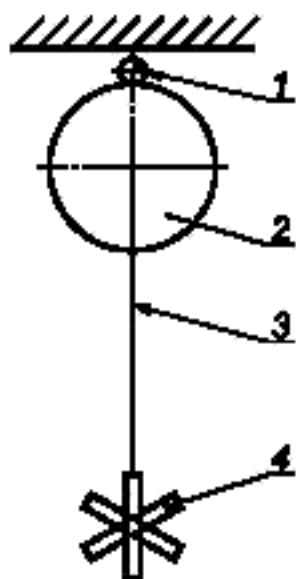
1 — анкерная точка опоры; 2 — средство защиты втягивающегося типа; 3 — втягивающийся строп;
