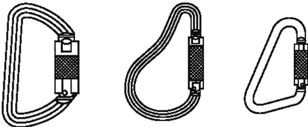
Рисунок 1 — Пример базового соединительного элемента (класс В)
