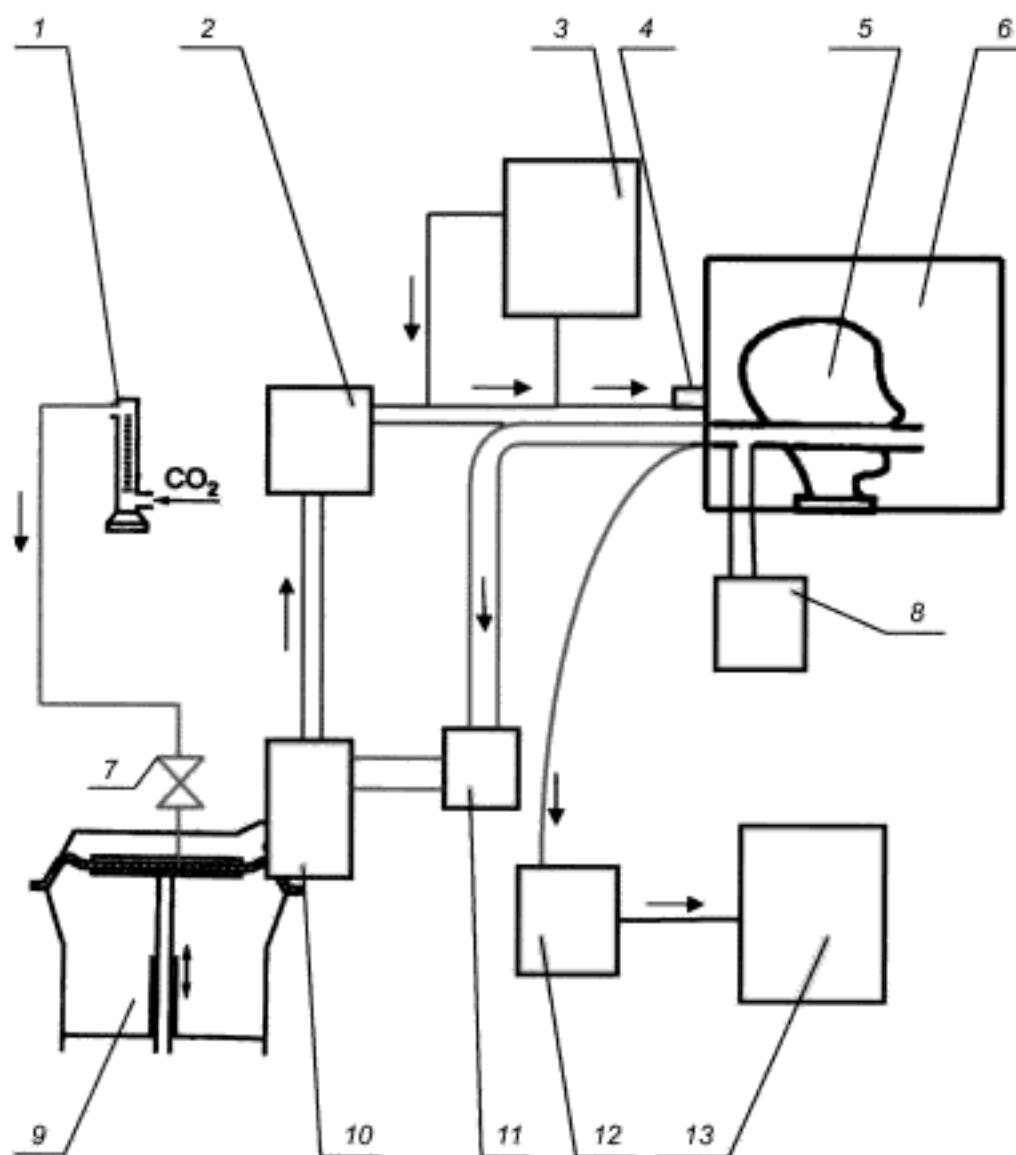
1 — дозатор диоксида углерода; 2 — термостат с увлажнителем; 3 — анализатор диоксида углерода; 4 — датчики температуры и влажности; 5 — «Шеффилдский» манекен головы человека; 6 — климатическая камера; 7 — односторонний клапан; 8 — прибор для измерения сопротивления дыханию; 9 — насос кискусственные легкие; 10 — клапанная коробка с клапанами вдоха и выдоха; 11 — поглотитель диоксида углерода; 12 — насос для отбора проб; 13 — анализатор диоксида углерода
