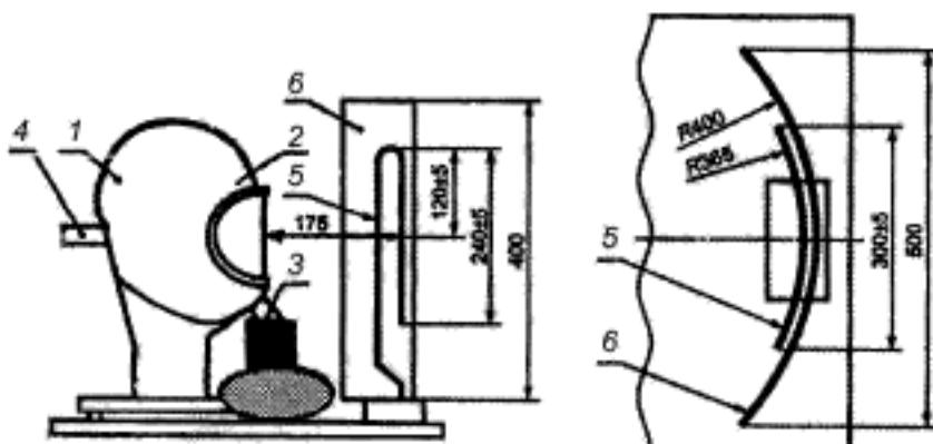
1 — металлический манекен головы человека; 2 — капюшон; 3 — регенеративный патрон; 4 — патрубок для подключения насоса «искусственные легкие»; 5 — источник теплового излучения; 6 — рефлектор
