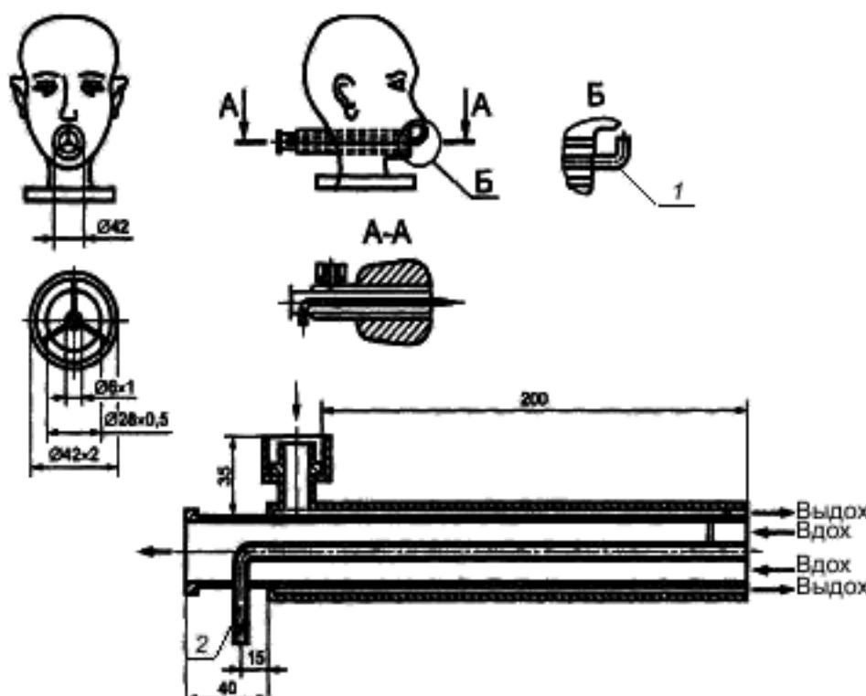
1 — патрубок для измерения сопротивления дыхания; 2 — патрубок для измерения СО<sub>2</sub>
