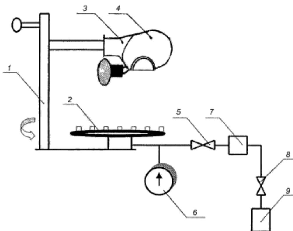
1 — стойка с ложементом для подвода самоспасателя в зону пламени; 2 — горелка с форсунками; 3 — металлический мулаж головы человека; 4 — капюшон самоспасателя; 5, 6 — вентили; 6 — прибор для измерения давления газа; 7 — редуктор; 9 — баллон с пропаном
