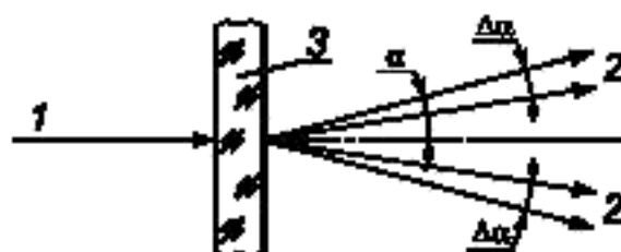
1 — падающий вдоль оптической оси световой поток; 2 — световой поток, прошедший через очковое стекло (светофильтр); 3 — очковое стекло (светофильтр)
