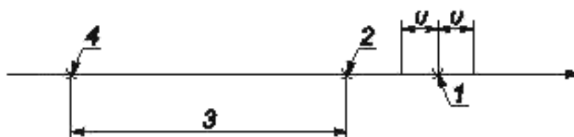
1 — результат измерения; 2 — верхний предел, заданный техническими документами; 3 — интервал, допускаемый техническими документами; 4 — нижний предел, заданный техническими документами
