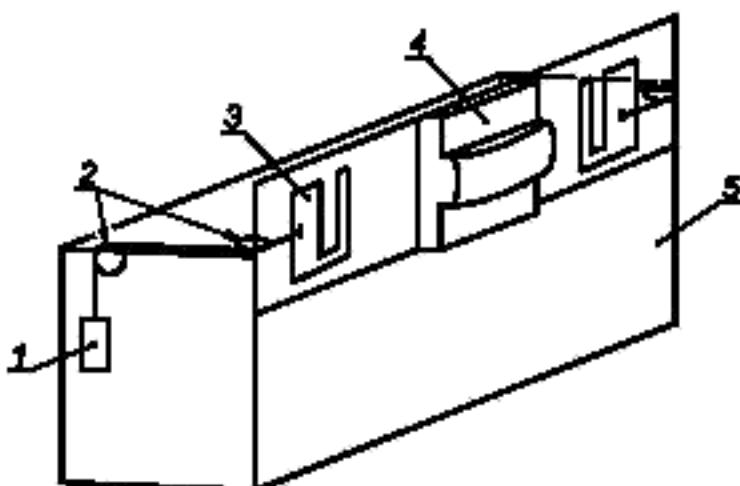
1 — противовес; 2 — шкивы; 3 — захват; 4 — блок опоры датчика; 5 — рама
