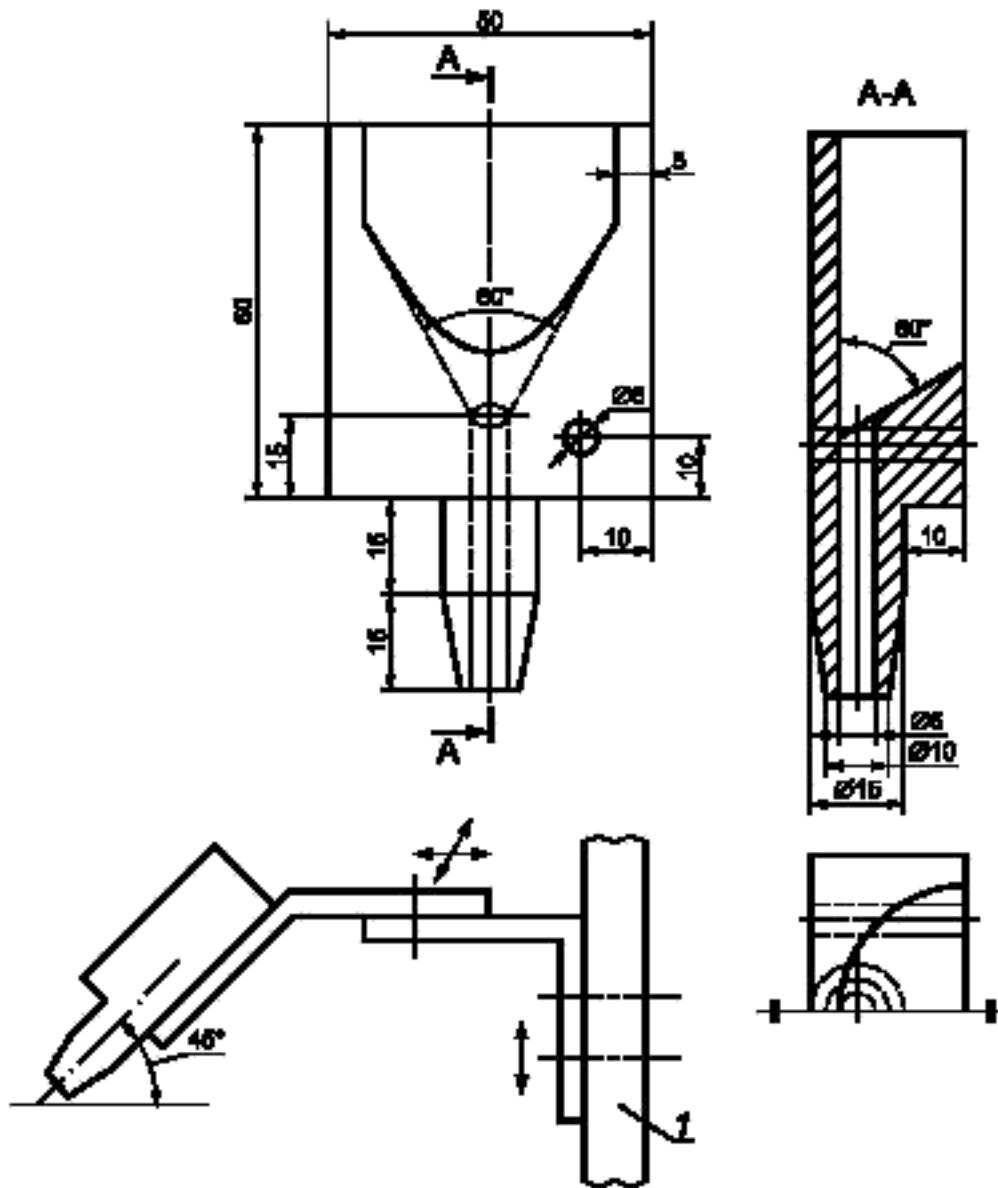
**П р и м е ч а н и е** — Рекомендуется отдельно изготавливать воронку и детали трубки направляющего приспособления, а затем скреплять их под прессом.
