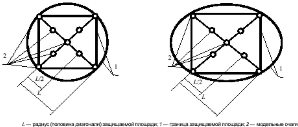
Рисунок 1 — Схема расположения модельных очагов пожара
