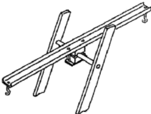
Рисунок 7 — Приспособление для испытания ступеньки на кручение
