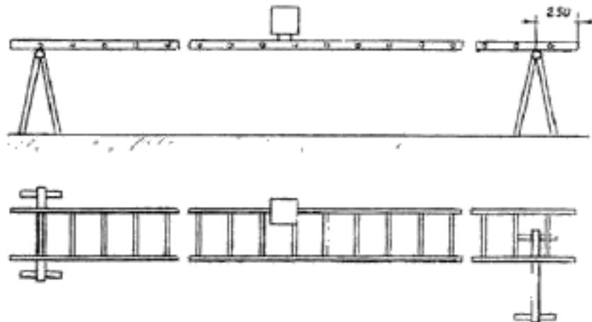
Рисунок 3 — Схема установки или подвески контрольного груза
