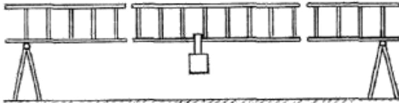
Рисунок 2 — Схема подвески контрольного груза
