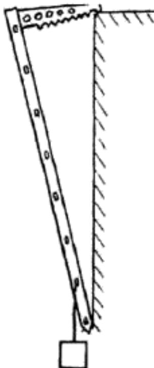
Рисунок 15 — Схема испытания крюка штурмовой лестницы на прочность
