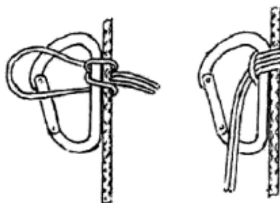
Рисунок 11 — Карабинный узел
