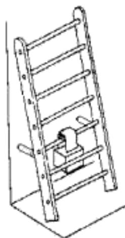
Рисунок 5 — Схема установки или подвески контрольного груза
