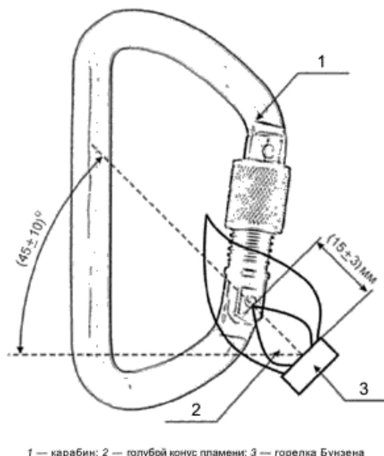
Рисунок 6 — Схема проверки работоспособности механизмов затвора и замыкателя после воздействия на них открытого пламени
