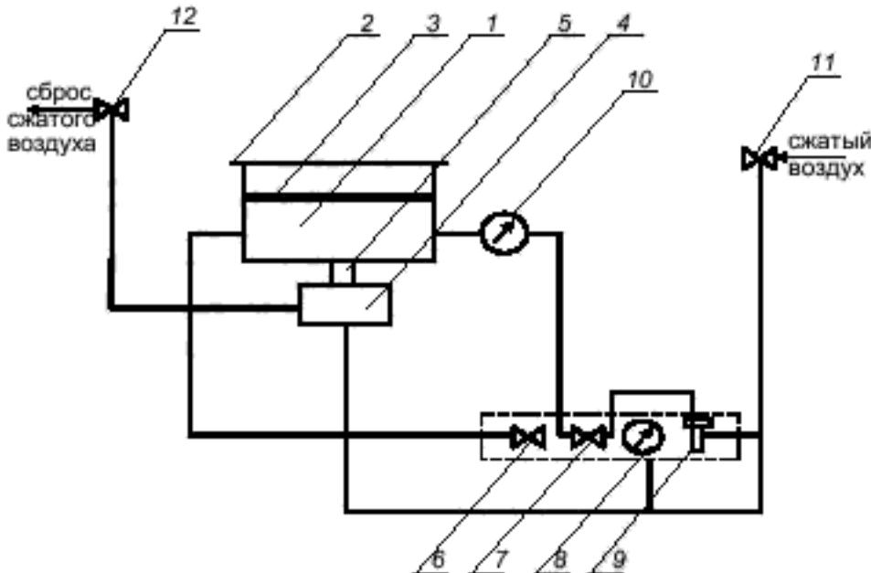
1 — рабочая камера; 2 — упорное кольцо; 3 — образец; 4 — пневмоцилиндр; 5 — шток; 6 — выпускной кран; 7 — выпускной кран; 8, 10 — манометры; 9 — воздушный редуктор; 11, 12 — вентиль
