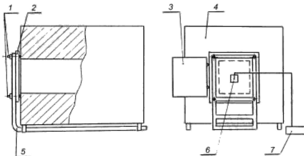
1 — испытываемый образец; 2 — шпильки; 3 — держатель образца; 4 — дверь камеры; 5 — электропечь;
