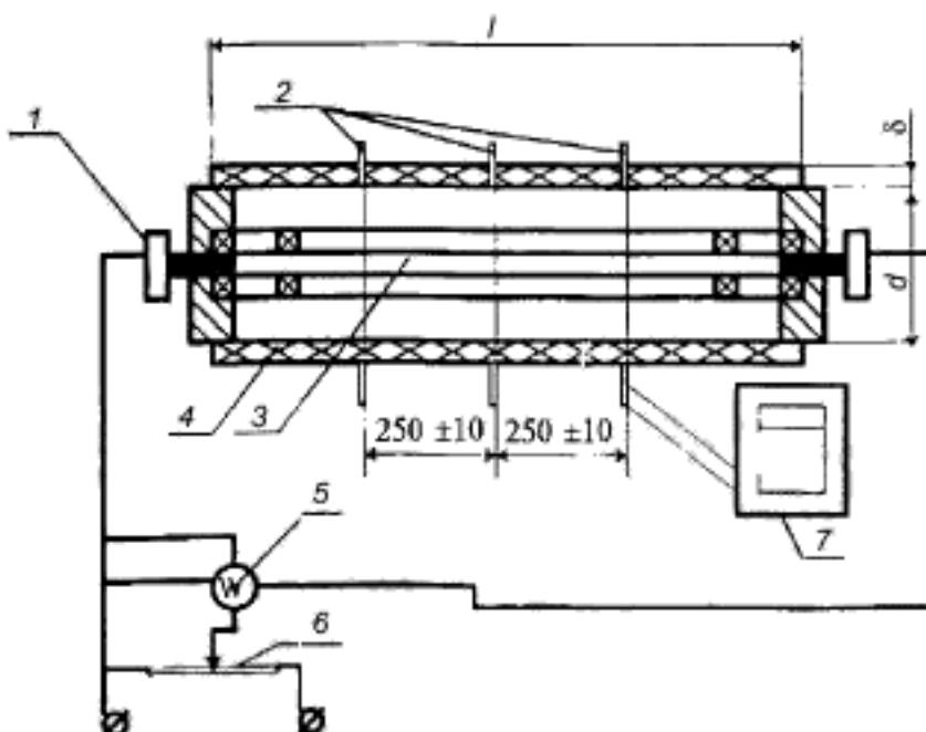
1 — токопроводящая втулка; 2 — термозлектрические преобразователи; 3 — электронагреватель; 4 — испытываемый материал; 5 — прибор контроля мощности ( $A$ ,  $V$ ); 6 — автотрансформатор; 7 — потенциометр
