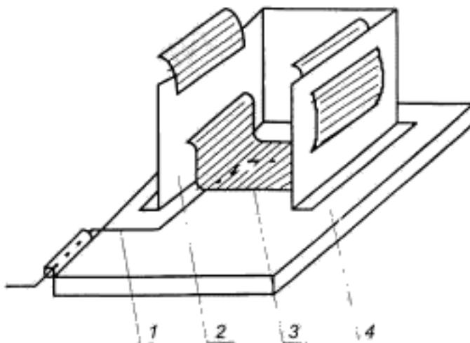
1 — термоэлектрический преобразователь; 2 — держатель; 3 — исследуемый образец; 4 — керамическая пластина
