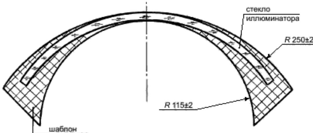
Рисунок 10 — Определение радиуса изгиба стекла иллюминатора
