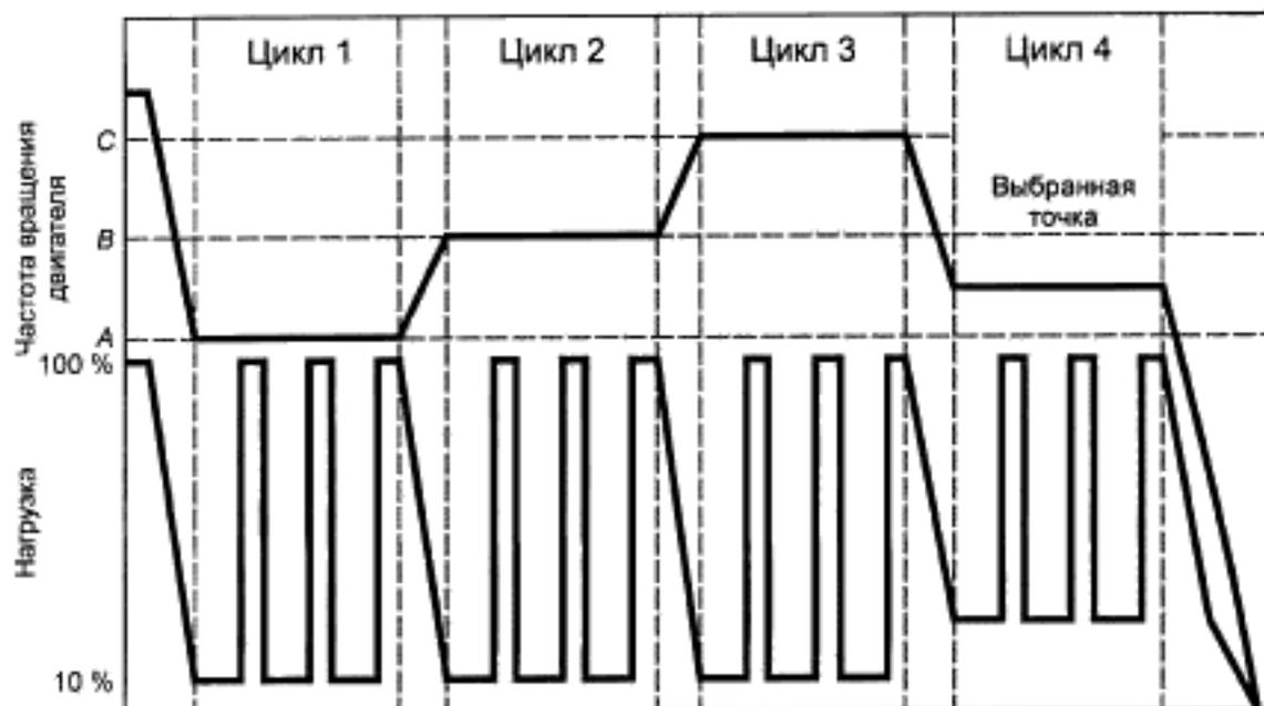
Рисунок Д.1 — Последовательность режимов в испытании ELR
