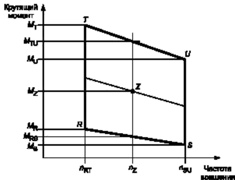
Рисунок Д.2 — Интерполяция удельного выброса  $\text{NO}_x$  для контрольной точки  $Z$
