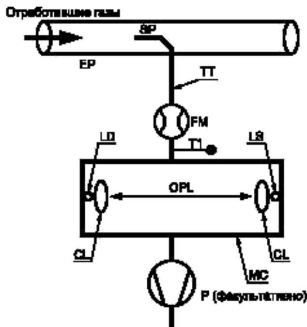
Рисунок Д.22 — Дымомер на частичном потоке
