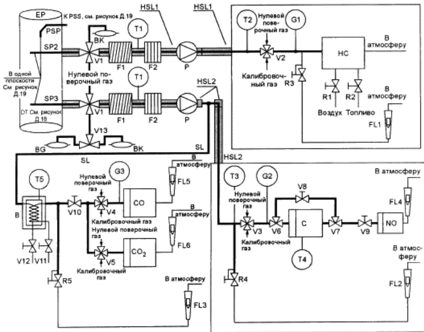
Рисунок Д.6 — Схема установки для анализа разбавленных отработавших газов с определением концентраций  $\text{CO}$ ,  $\text{CO}_2$ ,  $\text{NO}_x$ ,  $\text{HC}$  (для испытания ETC, факультативно — для испытания ESC)
