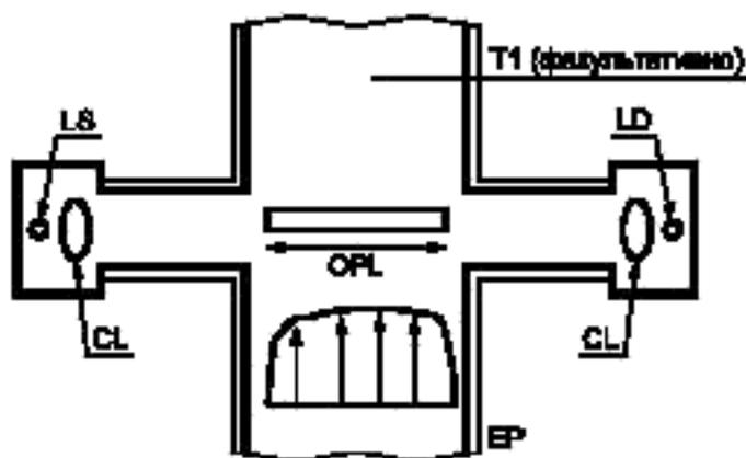
Рисунок Д.21 — Полнопоточный дымомер
