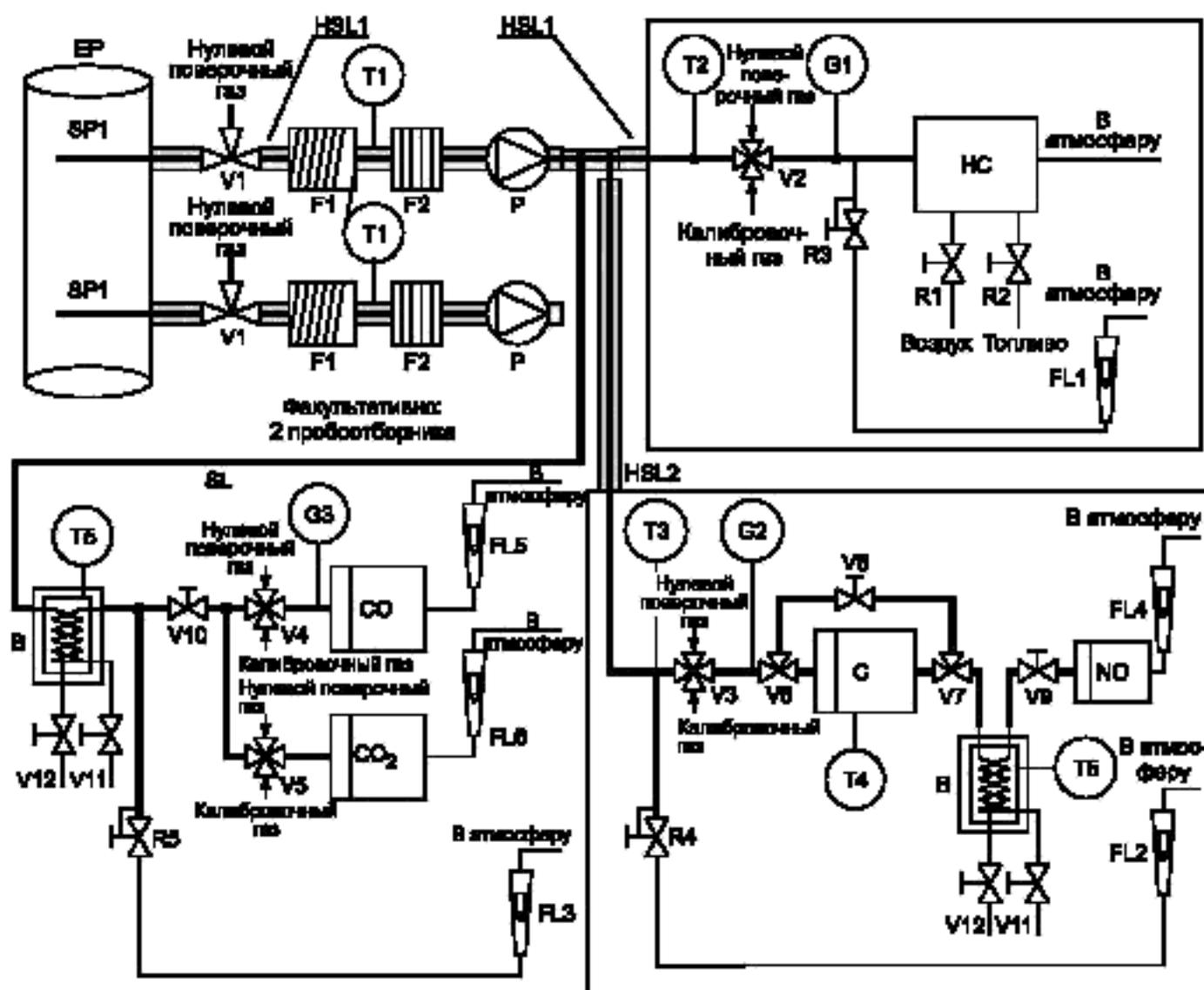
Рисунок Д.5 — Схема установки для анализа неразбавленных отработавших газов с определением концентраций CO, CO<sub>2</sub>, NO<sub>x</sub>, HC (только для испытания ESC)
