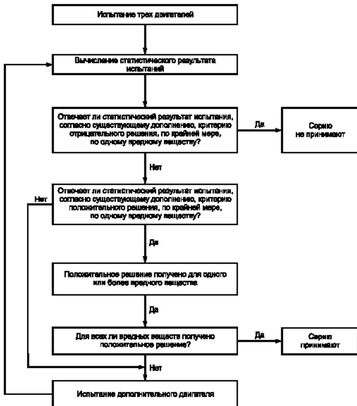
Рисунок 2 — Схема испытания на соответствие производства
