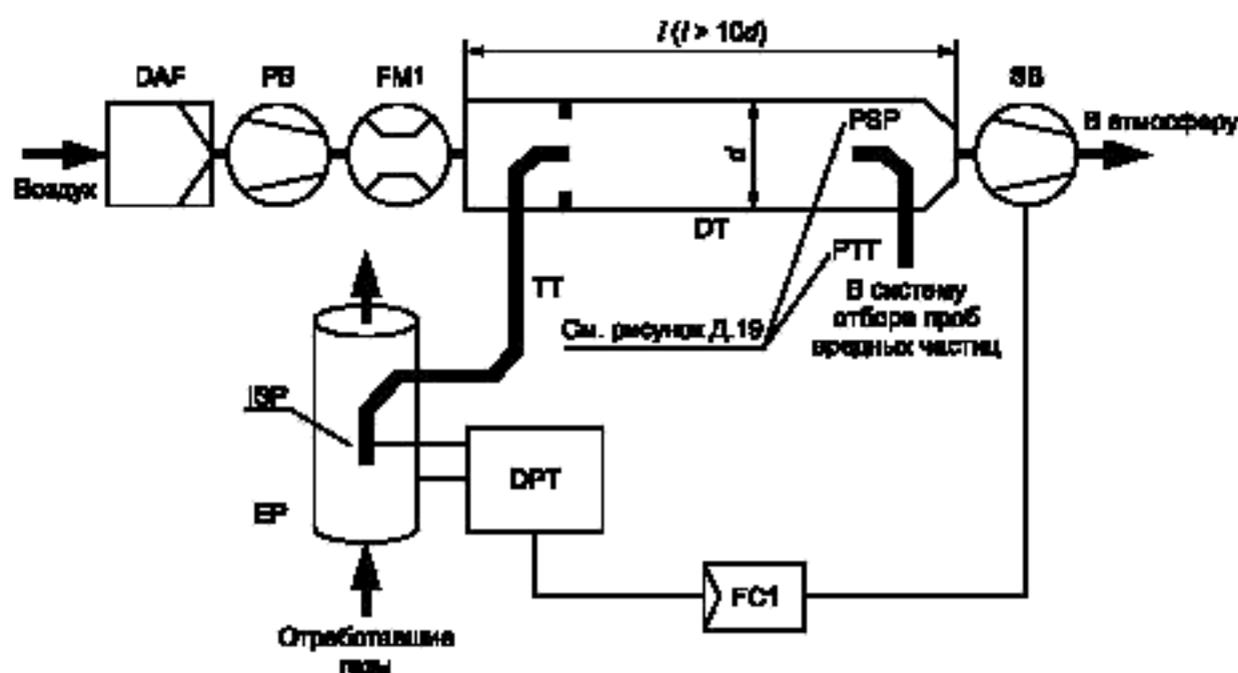
Рисунок Д.9 — Система с частичным разбавлением потока, изокинетическим пробоотборником и частичным отбором проб. Управление с помощью вытяжного насоса SB
