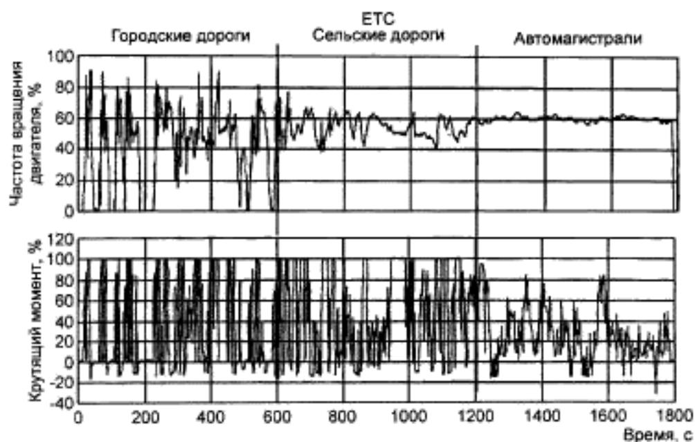
Рисунок Д.3 — Динамометрический график испытания ETC
