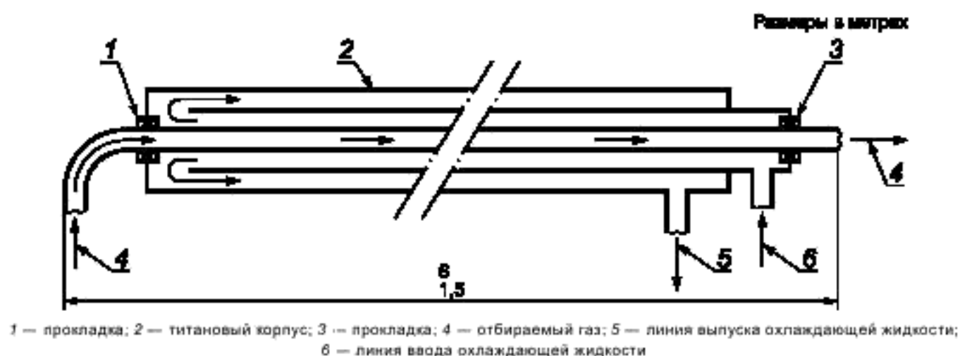
Рисунок В.8 — Пример охлаждаемого зонда
