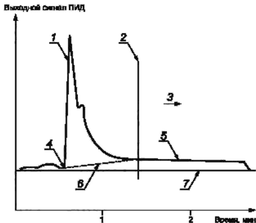
1 — пик НМЛОС; 2 — конечная точка интегрирования; 3 — продолжение нагрева ловушки; 4 — начальная точка интегрирования; 5 — смещение базовой линии из-за влажности; 6 — исправленная базовая линия, построенная интегратором для скорректированной площади пиков; 7 — обычная базовая линия
