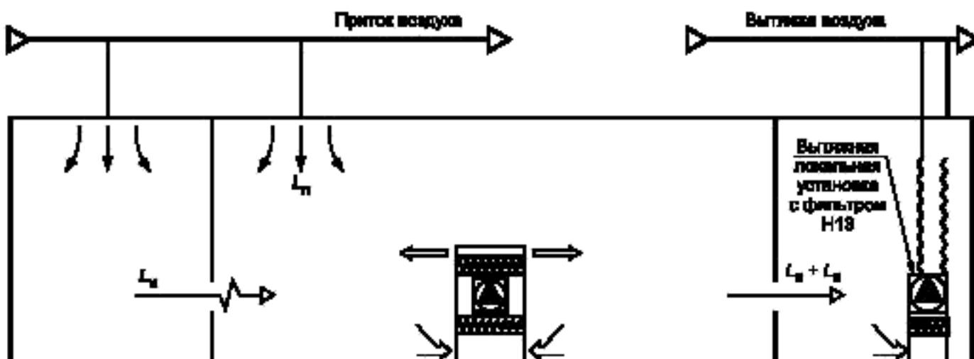
$L_p$  – расход приточного воздуха;  $L_u$  – расход воздуха за счет инфильтрации
