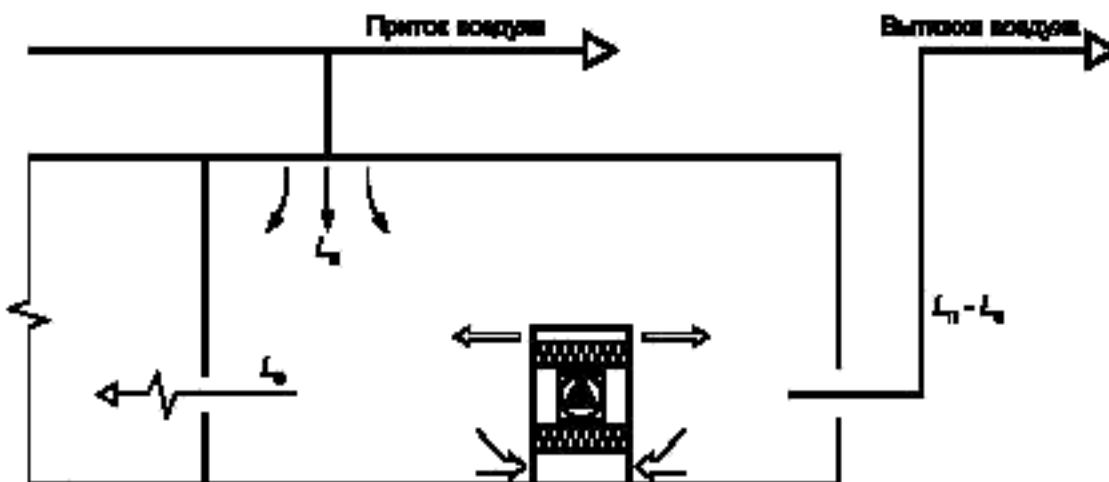
$L_p$  — расход приточного воздуха;  $L_z$  — расход воздуха за счет экспансионной фильтрации
