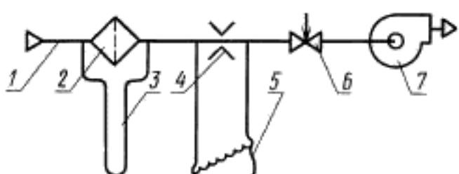
1 — воздуховоды; 2 — испытуемый фильтр-поглотитель; 3 — U-образный мановакуумметр; 4 — измерительная диафрагма; 5 — жидкостный микроманометр; 6 — регулирующее устройство; 7 — вентилятор или другой побудитель воздушного потока
