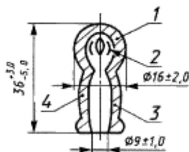
1 — сосковая часть; 2 — ребро жесткости; 3 — венчик; 4 — баллончик
