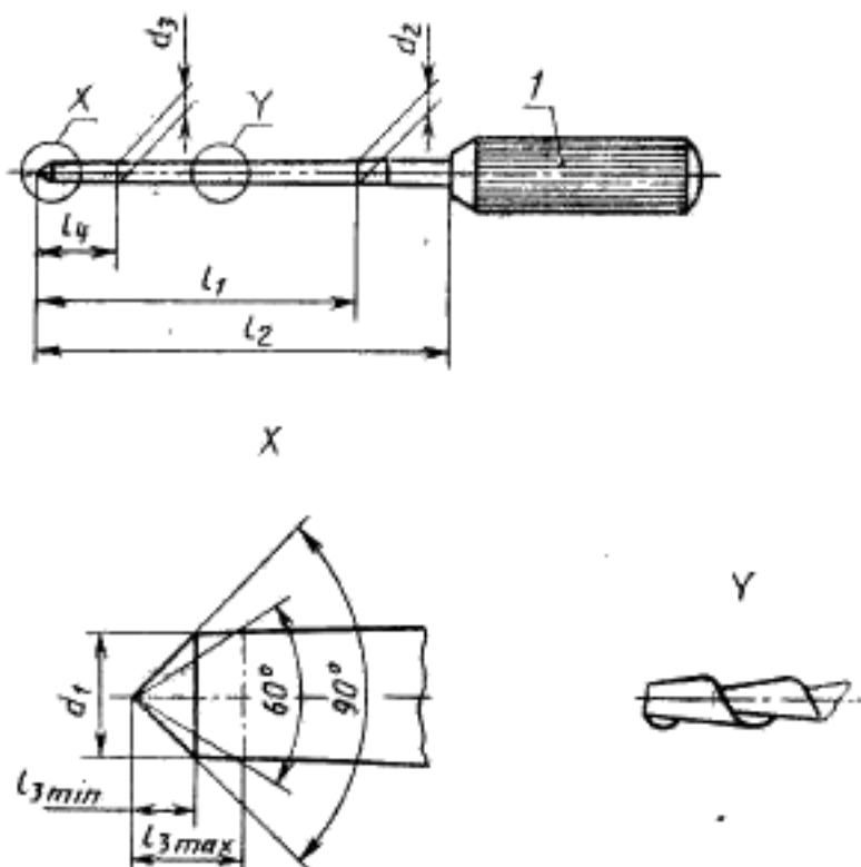
$d_1$  — начальный диаметр рабочей части;  $d_2$  — максимальный диаметр рабочей части;  $d_3$  — диаметр на длине  $l_1$ ;  $l_1$  — длина рабочей части;  $l_2$  — длина оперативной части;  $l_3$  — длина заходной части;  $l_4$  — длина до точки измерения
