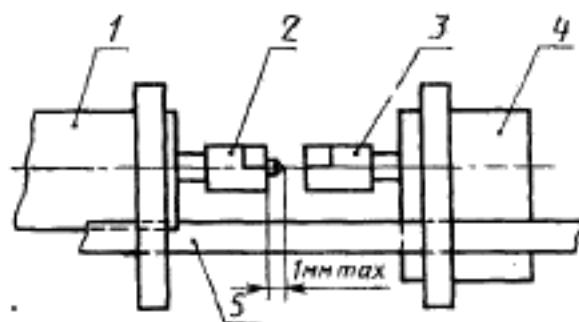
1 — реверсивный реостаторный двигатель; 2 — патрон с тисками из закаленной стали; 3 — патрон с тисками из мягкой латуни; 4 — устройство для измерения крутящего момента; 5 — линейные шариковые направляющие
