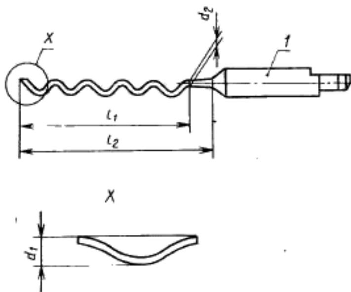
$d_1$  — начальный диаметр рабочей части;  $d_2$  — максимальный диаметр рабочей части;  $l_1$  — длина рабочей части;  $l_2$  — длина оперативной части
