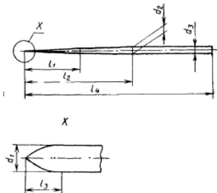
$d_1$  — начальный диаметр рабочей части;  $d_2$  — диаметр на конце оперативной части;  $d_3$  — диаметр ручки;  $l_1$  — длина рабочей части;  $l_2$  — длина оперативной части;  $l_3$  — длина заходной части;  $l_4$  — общая длина
