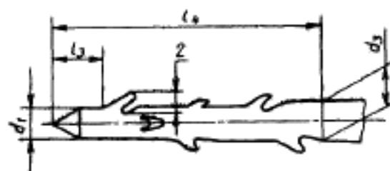
$d_1$  — начальный диаметр рабочей части; $d_2$  — диаметр по длине  $l_2$ ;  $l_1$  — длина рабочей части;  $l_2$  — длина оперативной части;  $l_3$  — длина заходной части от остряя до основания первого зубца;  $l_4$  — длина до точки измерения
