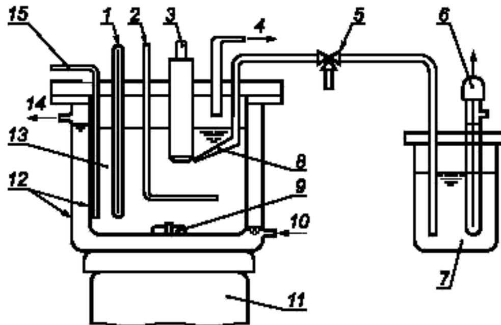
1 — термометр; 2 — противозэлектрод; 3 — рабочий электрод; 4 — выход газов; 5 — электролитический мостик; 6 — контрольный электрод (насыщенный хлоридом серебра, НХС); 7 — насыщенный раствор KCl; 8 — капилляр; 9 — магнитная мешалка, покрытая тефлоном; 10 — вход для воды; 11 — мотор для магнитной мешалки; 12 — сосуд с двойными стенками; 13 — раствор электролита; 14 — выход для воды; 15 — барботер (использующий азот)
