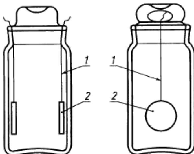
1 — проволока из нержавеющей стали; 2 — испытуемый образец
