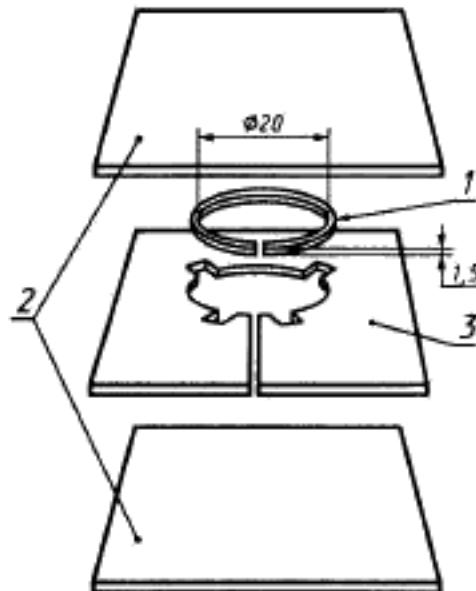
1 — разъемное кольцо; 2 — покровные пластины; 3 — фиксирующая пластина
