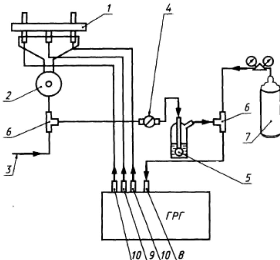
1 — кювето; 2 — распылитель; 3 — магистраль сжатого воздуха для питания распылителя; 4 — дроссель для регулирования расхода воздуха; 5 — пузырьковый индикатор расхода воздуха; 6 — тройник; 7 — баллон с аргоном; 8 — штуцер «Вход» генератора; 9 — кювета для подачи аргона; 10 — штуцер «Кювета» для подачи арсина
