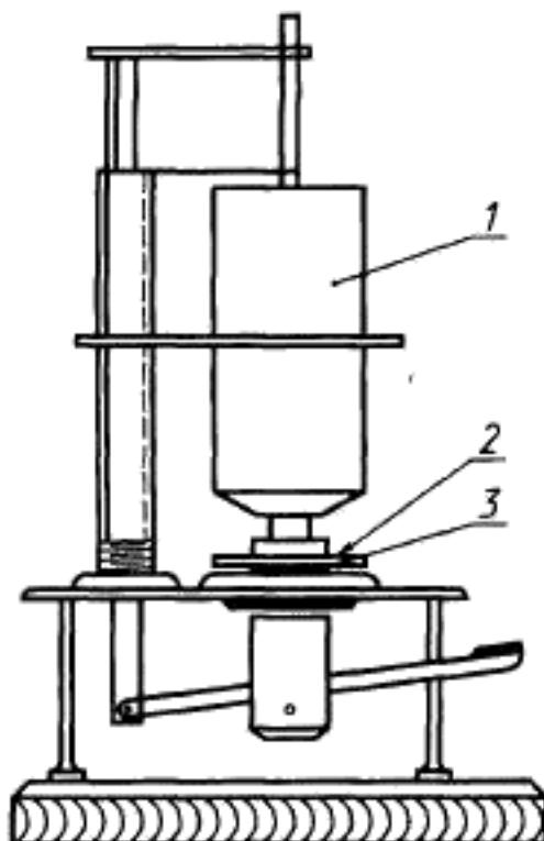
1 — нагрузка; 2 — стеклянная пластина; 3 — образец
