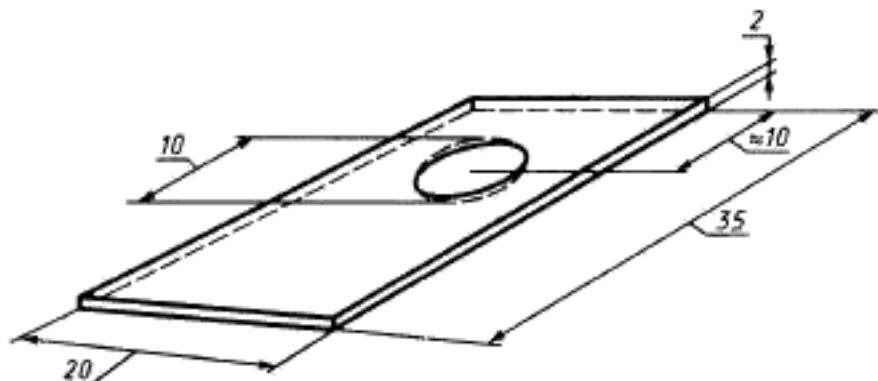
Рисунок 1 — Форма для определения времени твердения
