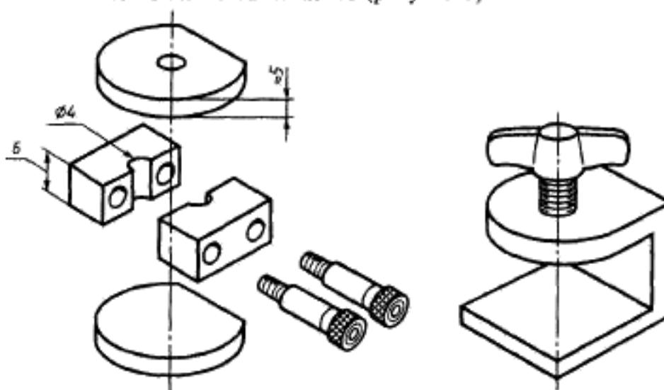
Рисунок 2 – Форма для приготовления образцов для испытания на прочность при сжатии
