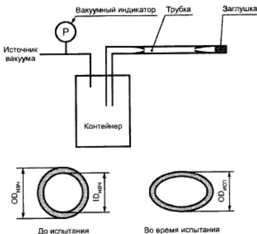
Рисунок А.1 — Аппарат для испытания гибких трубок
