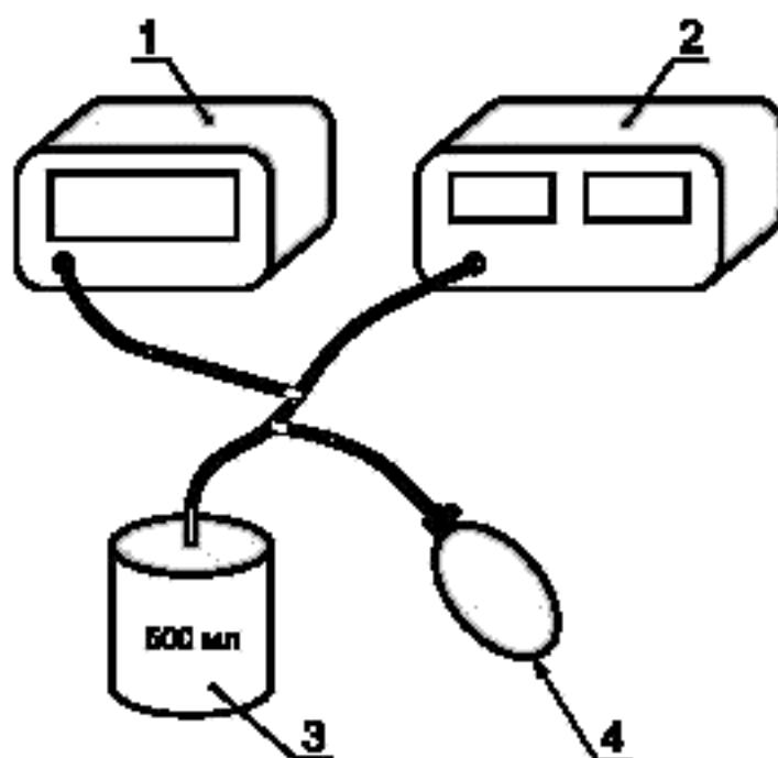
1 — эталонный манометр [8.1.1, перечисление б)]; 2 — манометр испытуемого устройства; 3 — металлический сосуд [8.1.1, перечисление а)]; 4 — нагнетатель давления [8.1.1, перечисление с)]
