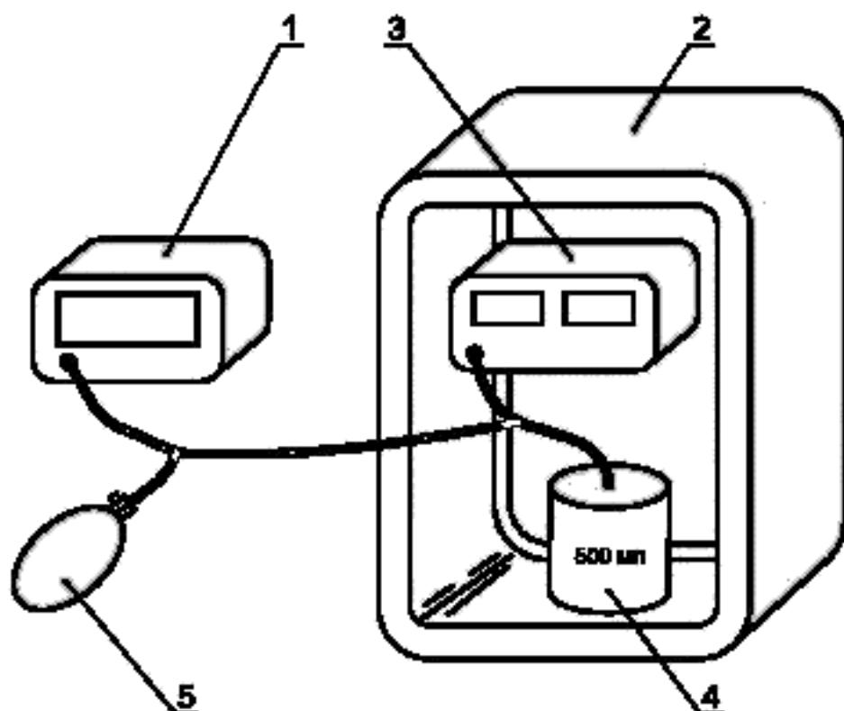
1 — эталонный манометр [8.1.1, перечисление б)]; 2 — климатическая камера [8.2.1, перечисление б)]; 3 — манометр испытуемого устройства; 4 — металлический сосуд [8.1.1, перечисление а)]; 5 — нагнетатель давления [8.1.1, перечисление с)]
