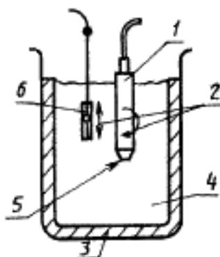
1 — ЛЕЧЕВНАЯ ГОЛОВКА; 2 — движение гидрофона в/или ЛЕЧЕВНОЙ ГОЛОВКИ; 3 — материал, поглощающий ультразвук; 4 — вода температурой  $(26 \pm 3)$  °C; 5 — излучающая поверхность; 6 — калибраторный гидрофон
