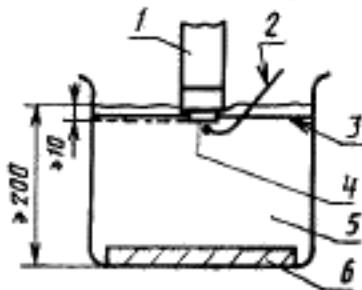
1 — ЛЕЧЕВНАЯ ГОЛОВКА; 2 — устройство для измерения температуры (может быть приложено к головке после изъятия ее из воды); 3 — опора для ЛЕЧЕВНОЙ ГОЛОВКИ; 4 — излучающая поверхность; 5 — вода начальной температурой  $(25 \pm 1)$  °C; 2 л; 6 — материал, поглощающий ультразвук
