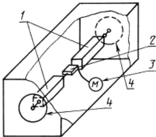
1 — сбалансированные безындуктивные сопротивления; 2 — термопара; 3 — индикаторное устройство;
