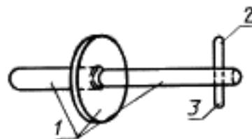
1 — изоляционный материал; 2 — металлический стержень диаметром 8 мм, имеющий конец в виде полусферы; 3 — заземление, имеющее малое сопротивление
