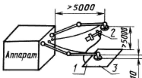
1 — заземление, имеющее малое сопротивление; 2 — испытательный штырь; 3 — металлическая пластина размерами не менее 30 × 30 см
