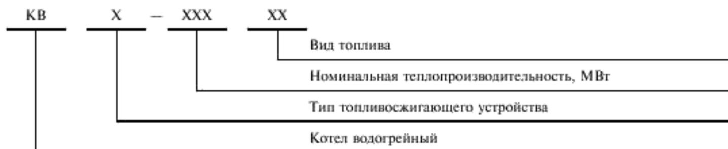
Примеры условных обозначений котлов: номинальной теплопроизводительностью 1,25 МВт с автоматической горелкой для газа низкого давления:
