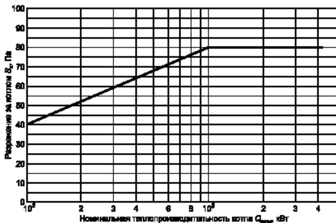
Рисунок 2 — Максимальное разрежение за котлом на естественной тяге
