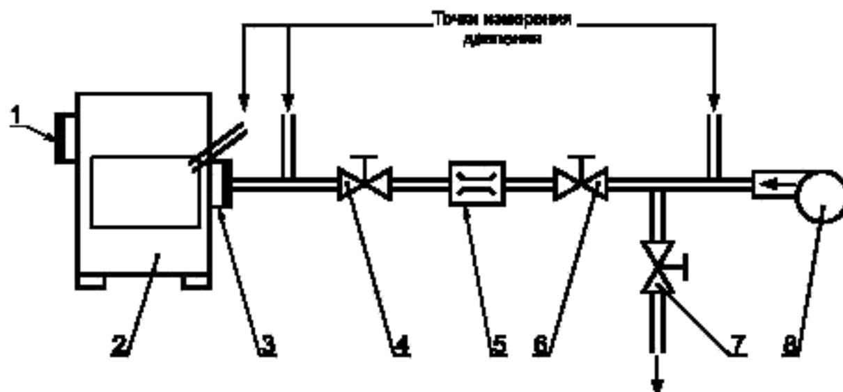
1 — патрубок уходящих газов; 2 — испытываемый котел; 3 — амбразура горелки; 4 — регулирующий орган 1; 5 — измеритель расхода; 6 — регулирующий орган 2; 7 — регулирующий орган 3; 8 — вентилятор
