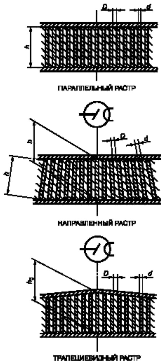
Рисунок 1 — Конструкция ОТСЕИВАЮЩИХ РАСТРОВ
