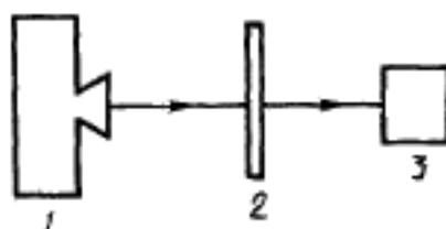
1—источник излучения (рентгеновский аппарат); 2—экран яркость которого измеряется; 3—яркометр (фотометр)
