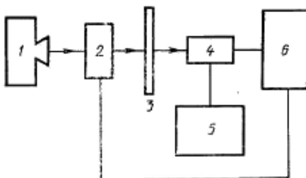
1 — рентгеновский аппарат (источник излучения); 2 — устройство для прерывания облучения экрана; 3 — экран; 4 — фотоэлектронный умножитель (ФЭУ); 5 — блок питания ФЭУ; 6 — осциллограф
