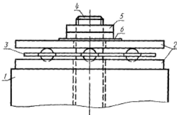
1—образец фундамента; 2—пластинки индикатора; 3—сепаратор с шариками; 4—анкерная тяга; 5—гайка и контргайка; 6—изоляция (полиэтиленовая прокладка)
