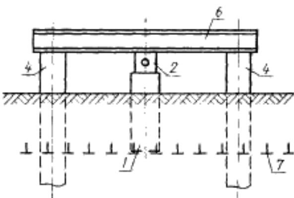
1—образец фундамента; 2—силоизмерительное устройство; 3—анкерная тяга; 4—анкерная свая; 5—анкерная плита; 6—система упорных балок; 7—подошва слоя сезонного промерзания-оттаивания грунта; 8—анкерная тяга с лопастями (для районов распространения вечномерзлых грунтов)
