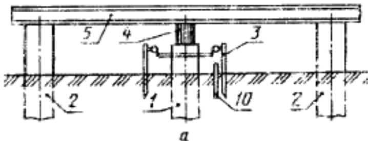
Установка с грузовой платформой, служащей упором для гидравлического дымкрана
