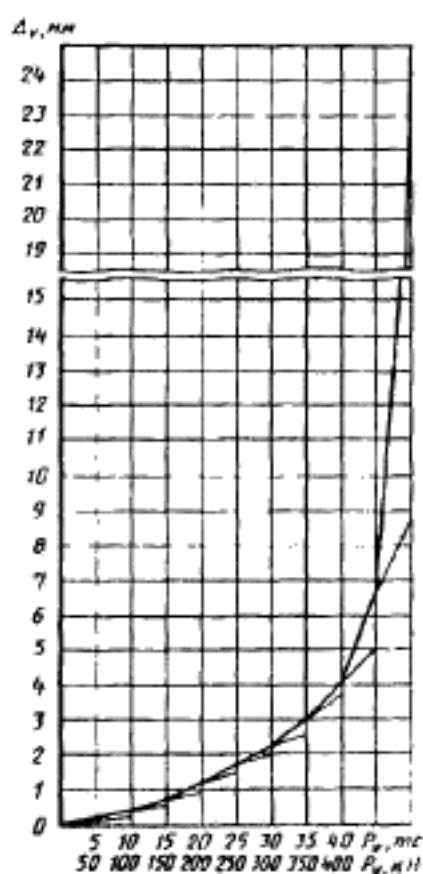
График изменения выхода свай из грунта  $\Delta$  по времени  $t$  (по ступеням нагружения)
