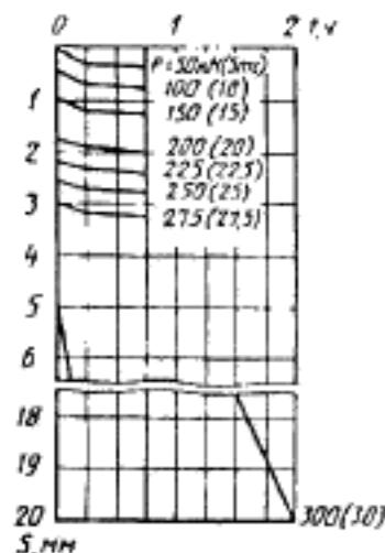
П р и м е ч а н и е — Аналогично графику  $S = f(P)$  зависимости общей осадки сваи  $S$  от нагрузки  $P$  строят графики зависимости перемещений законечника и ствола эталонных свай типов II и III и сваи-зонда от нагрузки.
