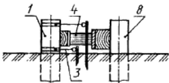
1 — испытуемая свая; 2 — анкерная свая; 3 — реперная система с прогибомерами; 4 — домкрат с микрометром; 5 — система упоров, балок; 6 — грузовая платформа; 7 — опора; 8 — груз (упор для домкрата); 9 — тарированный груз; 10 — термометрическое устройство; 11 — опорная панта-оголовок
