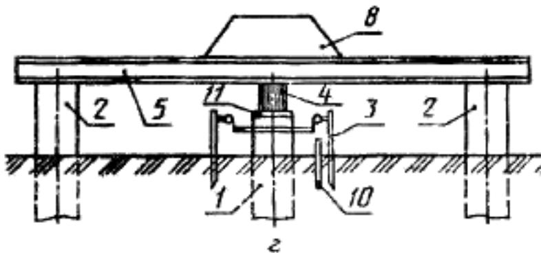
Схема установки для испытания грунтов статической выдерживающей нагрузкой
