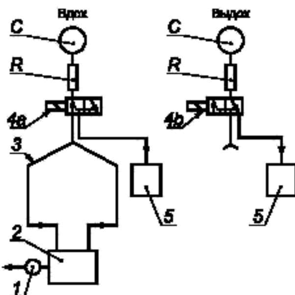
1 — проверяемое устройство для измерения дыхательного объема; 2 — АППАРАТ ИВЛ; 3 — дыхательный контур АППАРАТА ИВЛ; 4а, 4б — пневмопределитель; 5 — контрольное устройство
