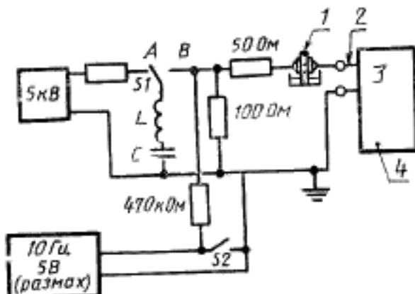
$$L=500 \text{ мкГн}, R_L \leq 10 \text{ Ом} \quad C=32 \text{ мкФ}$$
