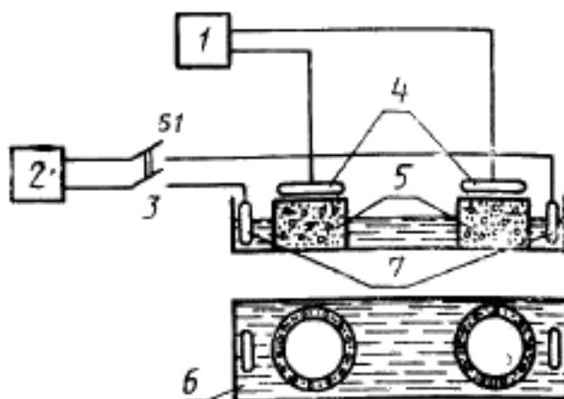
1 — АППАРАТ; 2 — генератор сигнала частотой 10 Гц; 3 — двухполюсный выключатель; 4 — ЭЛЕКТРОДЫ ДЕФИБРИЛЛИТОРА; 5 — губка; 6 — раствор NaCl; 7 — серебряные электроды
