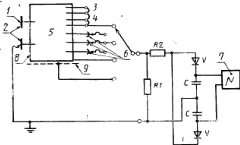
$R_1 = 1 \text{ кОм} \pm 2\% (\geq 2 \text{ кВ})$ ;  $R_2 = 100 \text{ кОм} \pm 2\% (\geq 2 \text{ кВ})$ ;  $C = 1 \text{ мкФ} \pm 5\%$ ;  $V$  — напомощенные кремниевые диоды; 1 — нет соединения; 2 — ЭЛЕКТРОДЫ ДЕФИБРИЛЛЯТОРА; 3 — сигнальная выходная часть; 4 — сигнальная входная часть; 5 — АППАРАТ; 6 — электроды монитора; 7 — осциллограф (ноги решетки); измерение напряжения в пределах  $\pm 5\%$ ; 8 — корпус АППАРАТА; 9 — металлическая фольга
