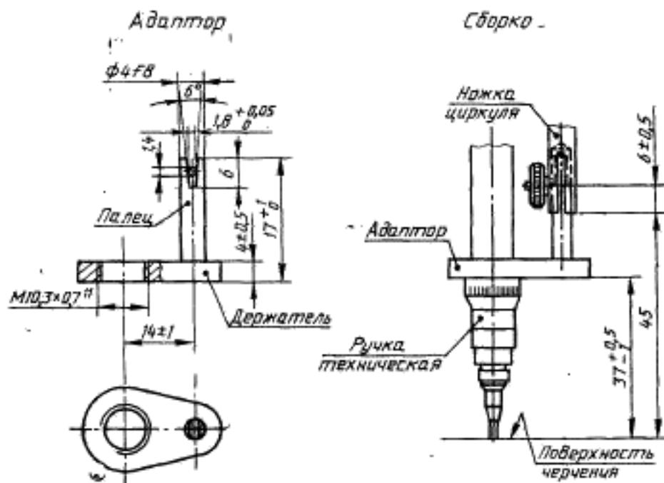
Рисунок 1 — Адаптор для циркулей с фиксированным пальцем
