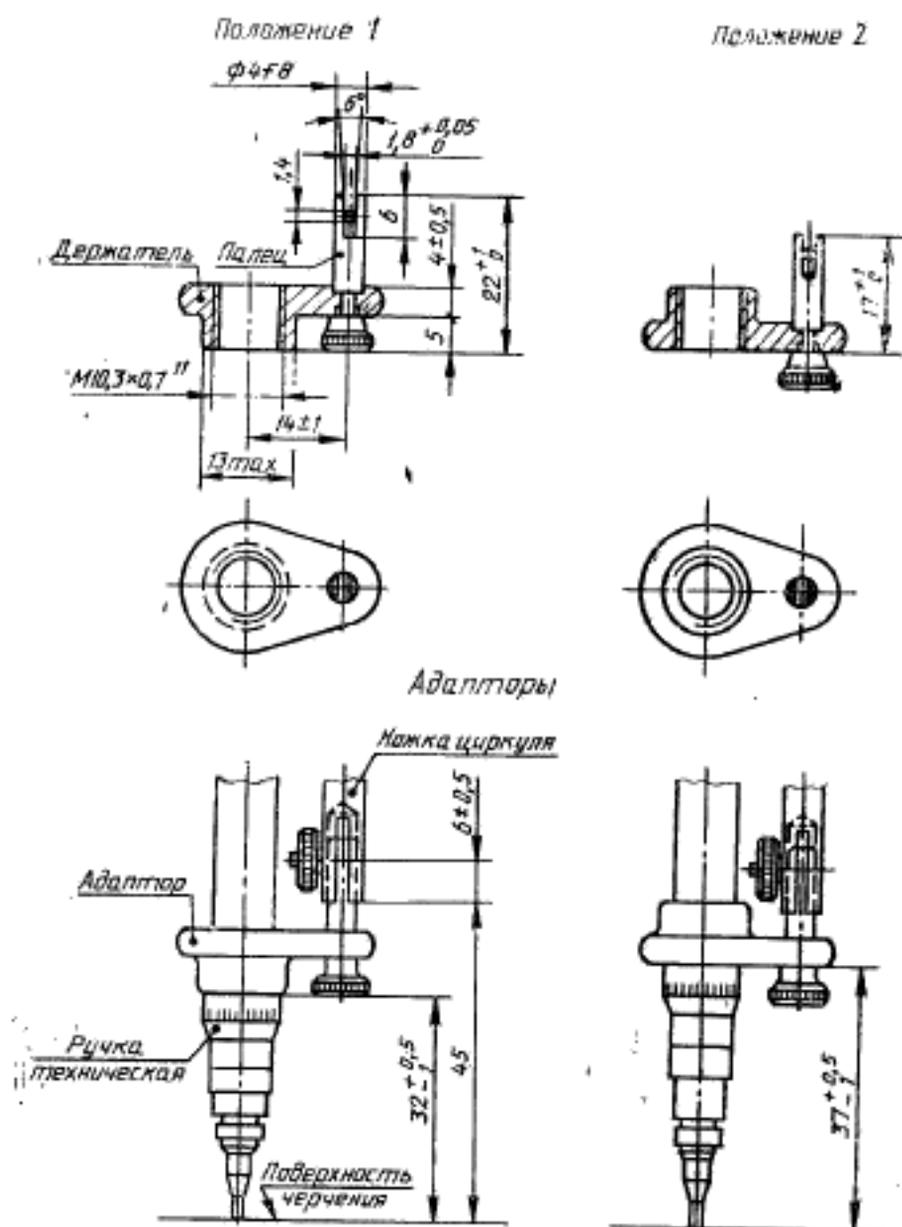
Рисунок 2 — Адаптер для циркулей с регулируемым пальцем
