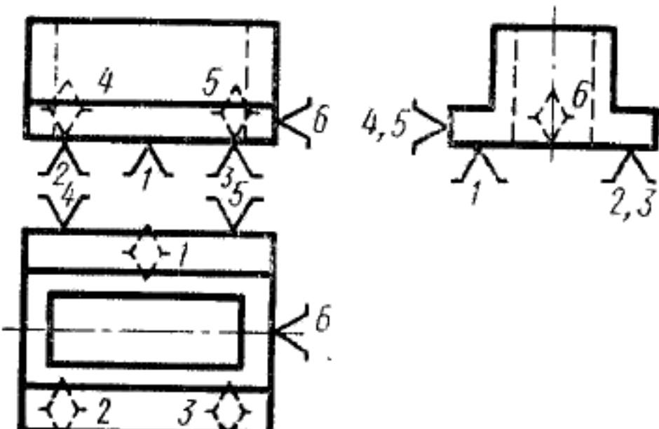
Установка заготовки по плоскости (на магнитной плите)
