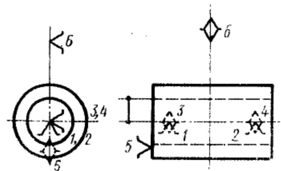
Установка на станке заготовки корпусной детали с выверкой ее положения по разметочным рискам
