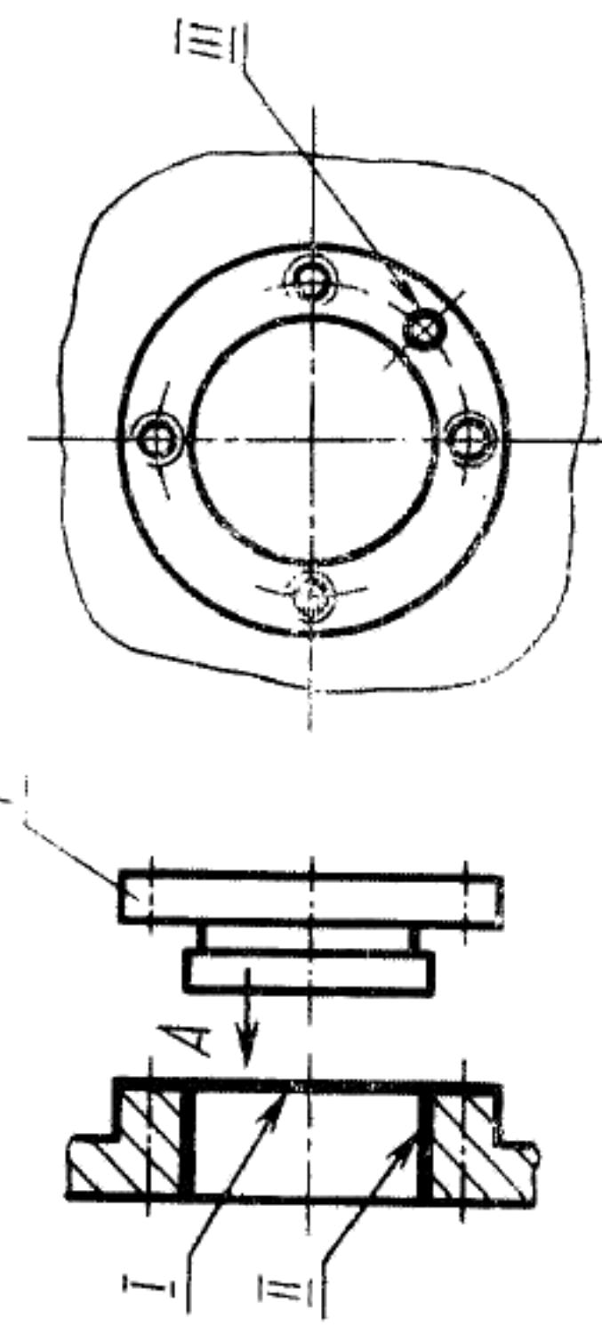
I, II, III — один из комплектов вспомогательных баз корпуса; I — присоединяемая деталь.
