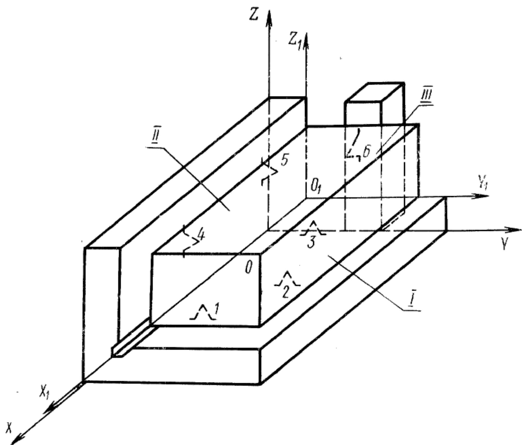
I — установочная база; II — направляющая база; III — опорная база;
