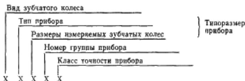
1.3. Пример условного обозначения прибора для измерения цилиндрических зубчатых колес, станкового, для зубчатых колес с модулем  $m \geq 1$  мм, для измерения кинематической погрешности, класса точности А:
