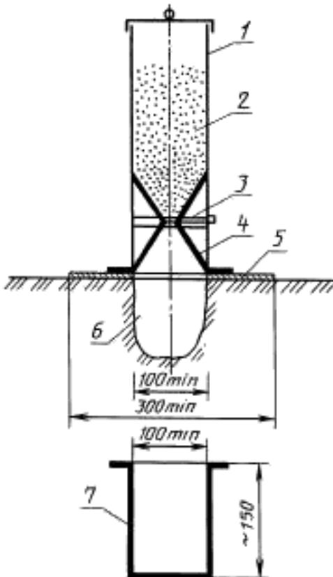
3.2.3. Определяют массу пескозагрузочного аппарата, вновь полностью наполненного песком ( $m_1$ ), и при закрытой задвижке помещают аппарат на лист основания, а лист основания — на отверстие калибровочного сосуда.
