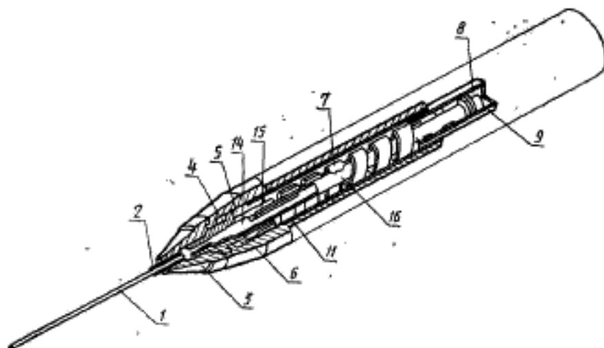
1 — грифель; 2 — трубчатая направляющая; 3 — металлический наконечник; 4 — соединительная втулка; 5 — втулка (вкладыш); 6 — нижний корпус (нижняя часть корпуса); 7 — винтовая поверхность (спираль); 8 — упор (фиксатор) спирали; 9 — кожух спирали; 10 — держатель (оправка) гильзы; 11 — гильза; 12 — верхний корпус (верхняя часть корпуса); 13 — манжета для установки ластика; 14 — трубка для грифеля (с трубчатой направляющей); 15 — выталкиватель; 16 — трубка с прорезью; 17 — кастик
