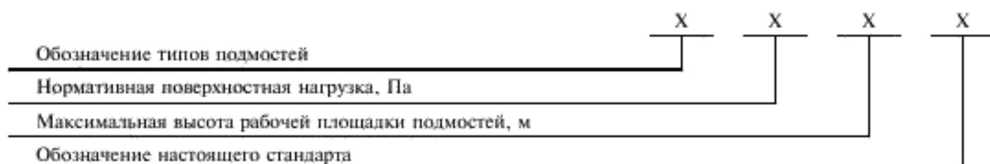
П р и м ер у с л о в н о г о обозначения подмостей передвижных сборно-разборных из плоских секций, с нормативным значением поверхности нагрузки 2000 Па и высотой рабочего настила 4,0 м:
