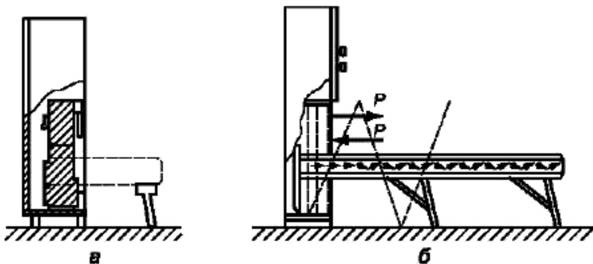
*a* — откидная встроенная кровать с цельной рамкой основания. Трансформация заключается в откидывании кровати; *б* — откидная встроенная кровать со складной рамкой основания. Трансформация идет в несколько этапов: извлечение кровати из корпуса изделия, организация спального места — раскладывание каркаса кровати
