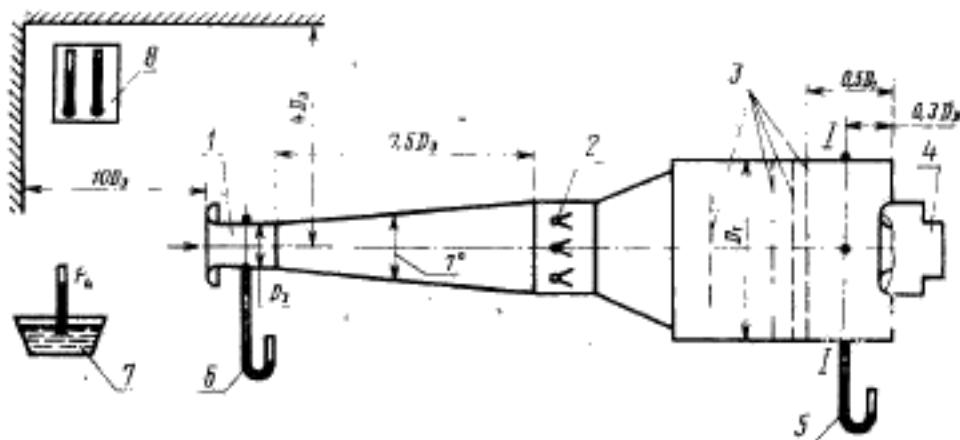
1—расходомер (сопло Вентури); 2—дросселирующее устройство (щит, сетки, перфорированные пластинки, спиральные решетки и т. д.); 4—агрегат; 5—дифманометр для измерения статического давления в камере; 6—дифманометр для измерения разности давлений в расходомере; 7—барометр для измерения атмосферного давления; 8— психрометр для измерения температуры и влажности атмосферного воздуха
