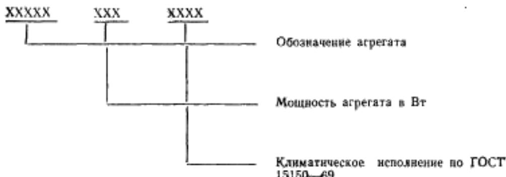
Пример условного обозначения агрегата АВП-4 мощностью 600 Вт, климатического исполнения УХЛ4:
