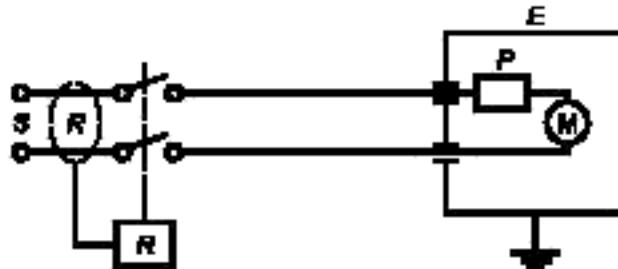
S — источник питания; E — корпус электродвигателя; R — устройство защитного отключения ( $I_{\text{з.н.}} = 30$  мА) (с/без встроенной токовой защиты); P — защитное устройство (внешнее или внутреннее); M — электродвигатель
