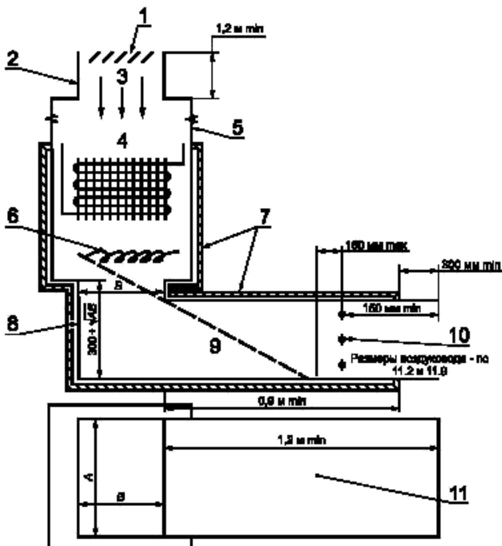
Рисунок 101б — Схема установки для проведения испытания на нагрев приборов с дополнительными нагревателями — для нисходящего потока.
