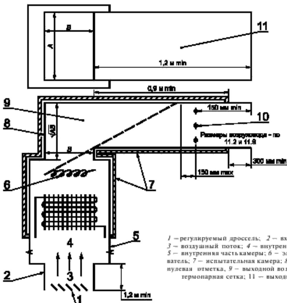
1 — регулируемый дроссель; 2 — входной трубопровод; 3 — воздушный поток; 4 — внутренний блок спиралей; 5 — внутренняя часть камеры; 6 — электрический нагреватель; 7 — испытательная камера; 8 — метка зазора или нулевая отметка; 9 — выходной воздуховод; 10 — термоизоляция сетка; 11 — выходной воздуховод.
