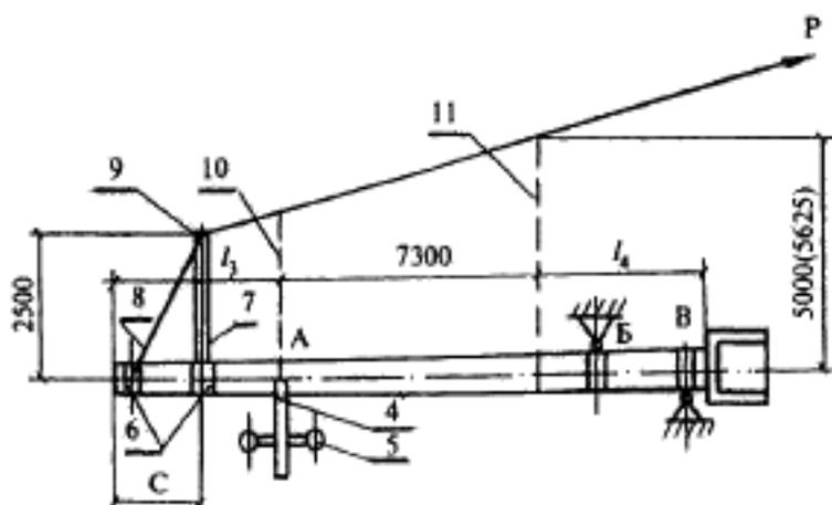
1 — шарнирно-скользящая опора; 2 — шарнирно-неподвижные опоры; 3 — упор в торце; 4 — измерительная рейка; 5 — неподвижный репер; 6 — стальные хомуты; 7 — прямая консоль; 8 — тяга; 9 — трос; 10 — уровень контактного провода; 11 — уровень условного обреза фундамента;
