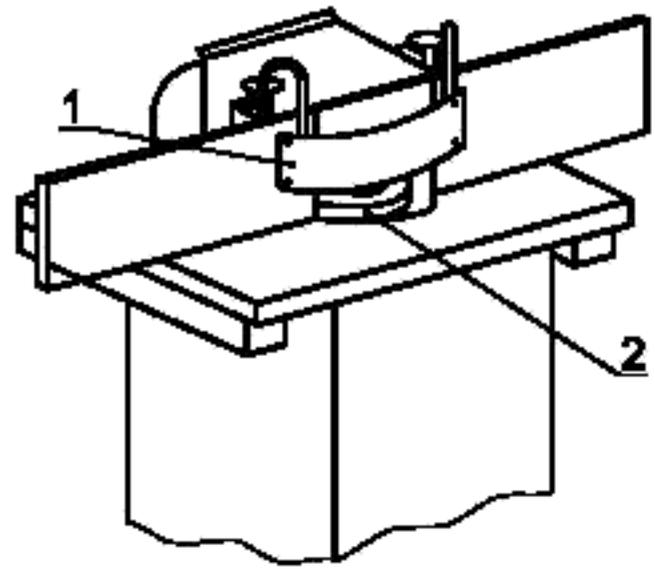
1 – защитный кожух; 2 – режущий узел
