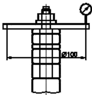
Рисунок 103 — Испытание на биеие дистанционных колец шпинделя
