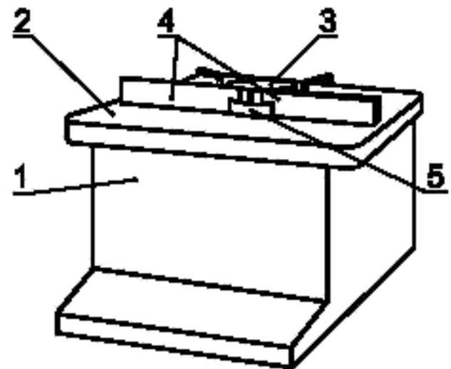
1 – опора; 2 – стол; 3 – режущий узел; 4 – направляющая;
