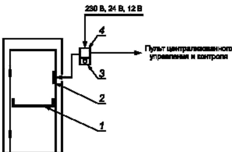
1 — основное замковое устройство «Антипаника», удерживающее дверь в закрытом состоянии; 2 — дополнительный электромеханический блокирующий механизм, разблокируется только электрическим сигналом; 3 — кнопка экстренного отпирания элемента 2; 4 — блок управления и контроля
