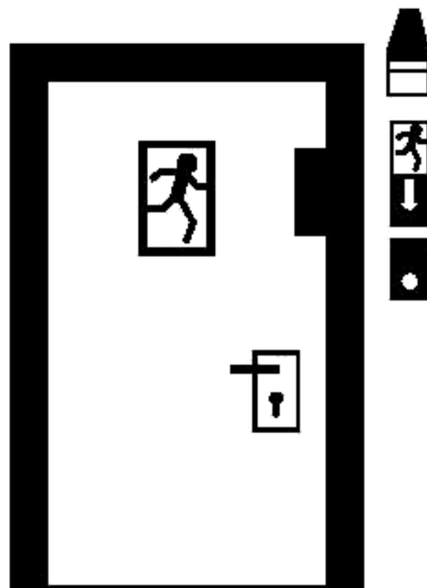
Рисунок Б.5 — Пример электрически управляемого устройства «Антипаника» для дверей аварийных выходов
