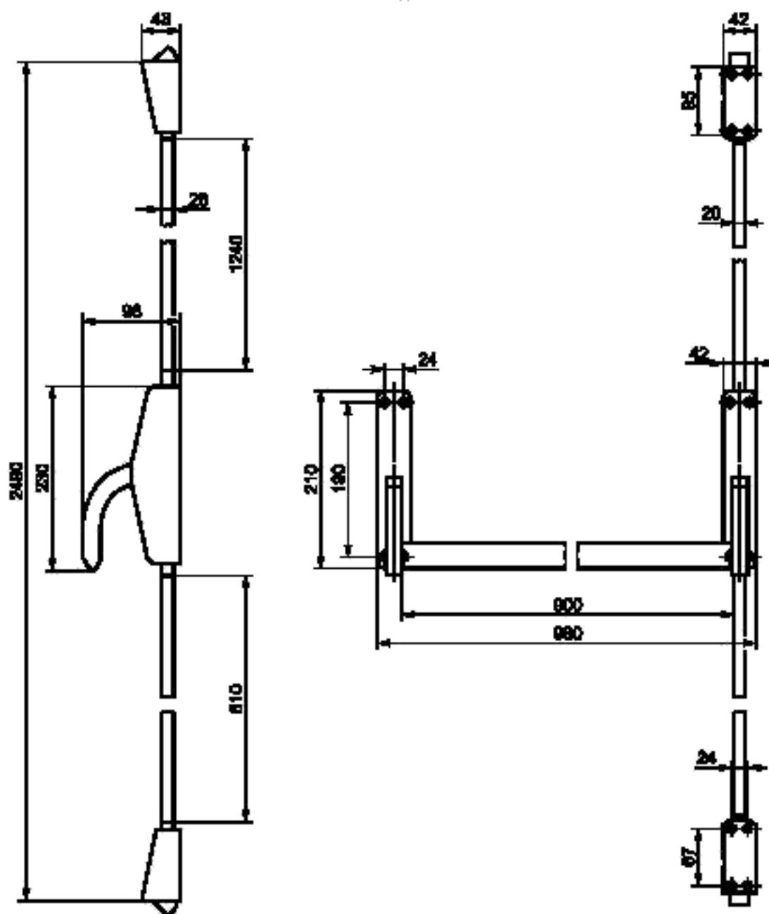
Рисунок А.3 — Пример устройства «Антипаника», управляемого штангой с запиранием дверей эвакуационных выходов в трех точках
