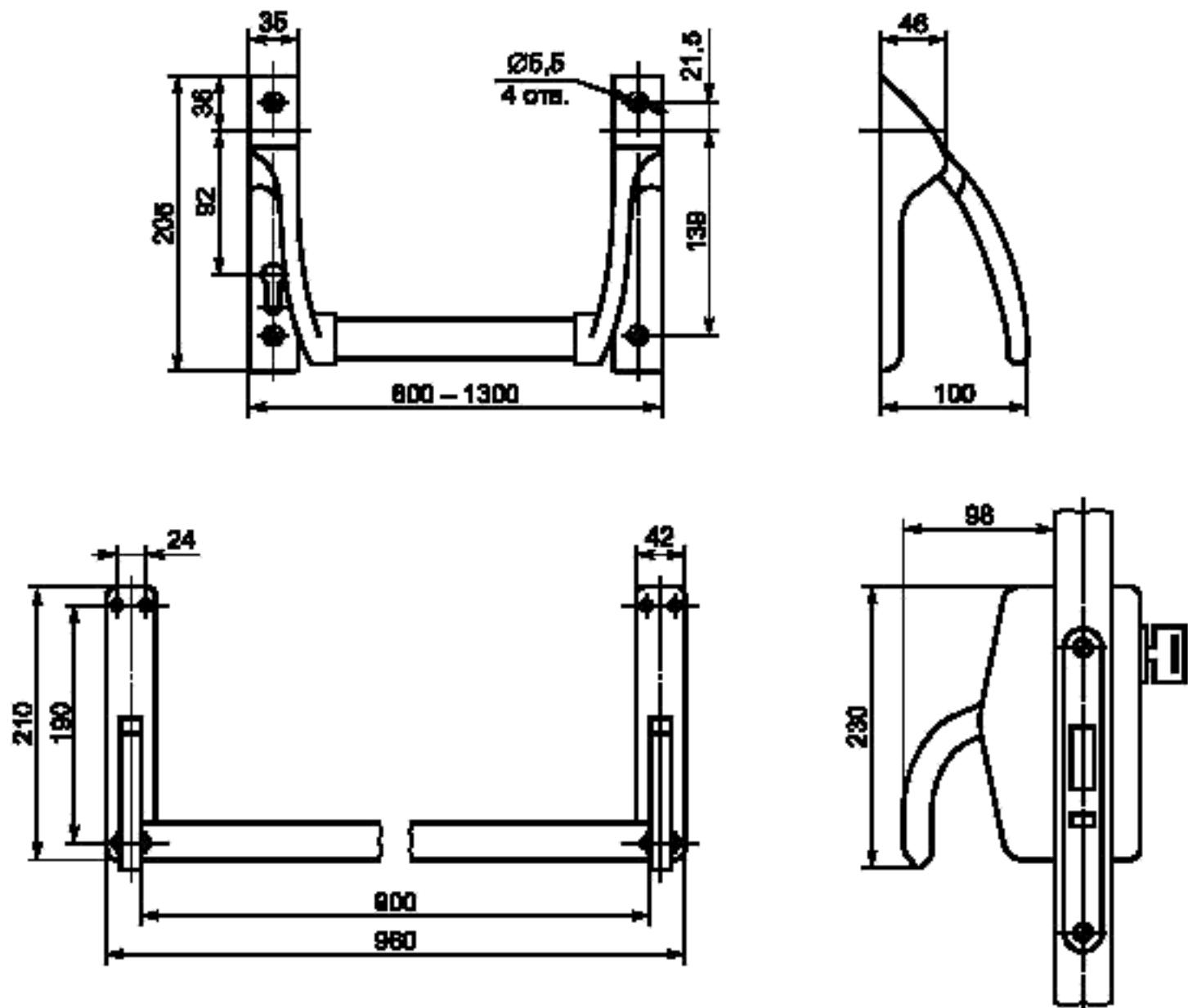
Рисунок А.1 — Примеры устройства «Антипаника», управляемого штангой
