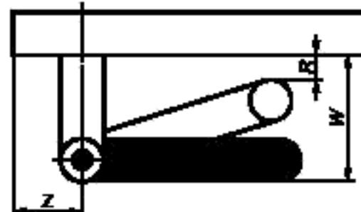
$R$  — минимальное расстояние между ручкой в нажатом состоянии и поверхностью полотна дверного блока;  $W$  — максимальный размер устройства (в плане);  $Z$  — минимальное расстояние до края полотна дверного блока
