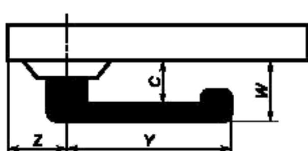
$C$  — минимальное расстояние между ручкой и поверхностью полотна дверного блока;  $W$  — максимальный размер устройства (в плане);  $Y$  — минимальная длина ручки;  $Z$  — минимальное расстояние до края полотна дверного блока
