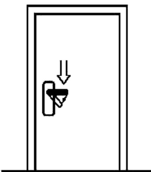
Рисунок 3 — Общий вид устройства «Антипаника» для дверей аварийных выходов с поворотной ручкой (тип А)
