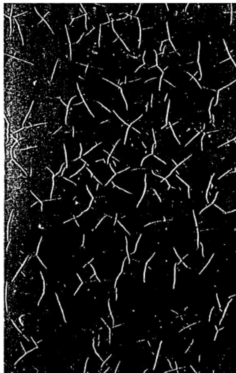
Рисунок 5 — Образование трещин лакокрасочного покрытия
