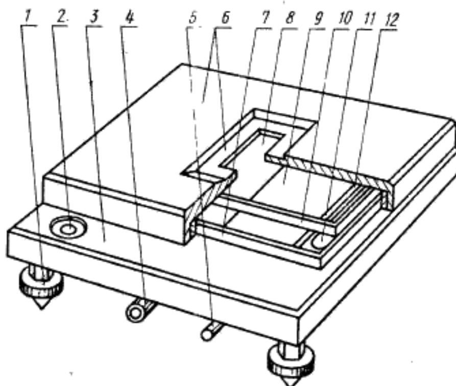
1—винты опорные; 2—уровень; 3—основание; 4—рычаг для перемещения кассеты; 5—рычаг для подъема предметного стекла; 6—крышка с гнездом для головки блескомера; 7—стекло предметное; 8—стекло черное; 9—стекло белое; 10—стекло покрывающее; 11—пластина металлическая; 12—кассета.
