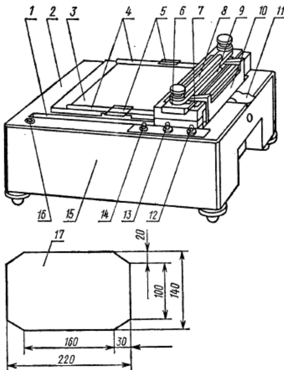
1—паз для направления хода каретки; 2—основание; 3—планшет; 4—планки для крепления бумаги; 5—прижимы; 6—оправа валика; 7—каретка; 8—бункер; 9—валик; 10—кронштейн; 11—пружина; 12—выключатель; 13—пускател; 14—предохранитель; 15—кофух; 16—уровень; 17—формат бумаги.
