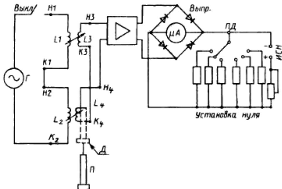
$G$  — генератор;  $L_1$  и  $L_2$  — катушки индуктивности первичные;  $L_3$  и  $L_4$  — катушки индуктивности вторичные;  $H_1$ ,  $H_2$ ,  $H_3$ ,  $H_4$  — начало обмоток;  $K_1$ ,  $K_2$ ,  $K_3$ ,  $K_4$  — конец обмоток; Выпр. — выпрямитель;  $\mu A$  — микроамперметр; ПД — переключатель диапазонов; Установка нуля — переменное сопротивление установки нуля; П — патрон с испытуемым образцом; ИСН — источник стабилизированного напряжения; Д — датчик; У — усилитель; Выкл. — выключатель
