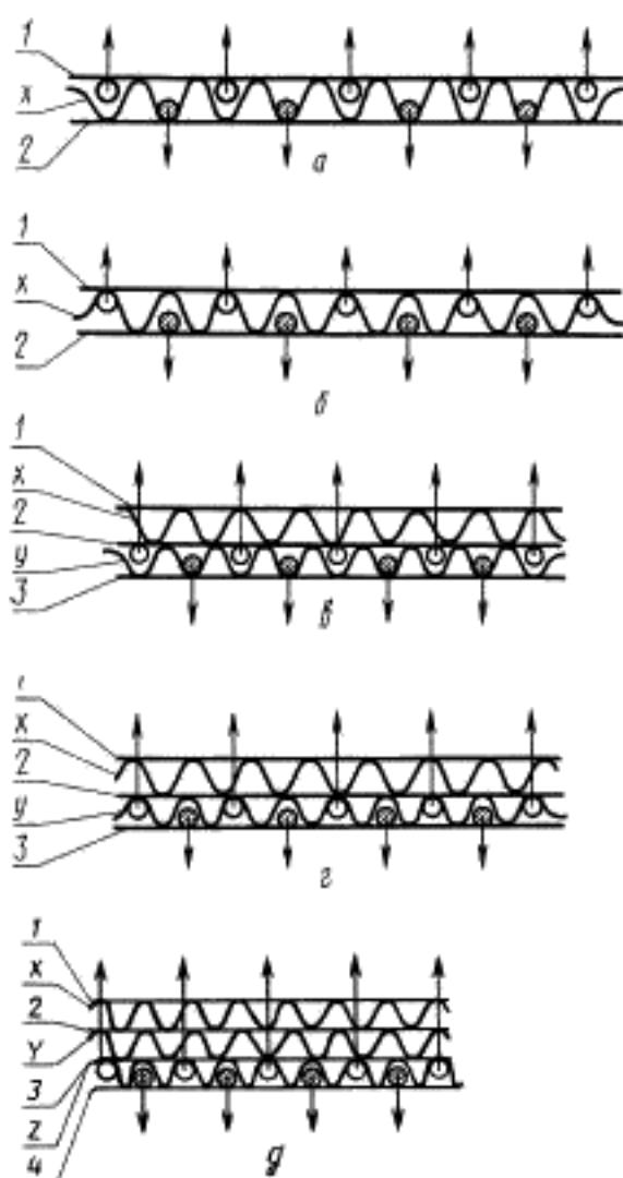
1, 2, 3, 4 — плоские слои; x, y, z — гофрированные слои; a — расслаивание слоев 1 и x; б — расслаивание слоев 2 и x; в — расслаивание слоев 2 и y; г — расслаивание слоев 3 и y; д — расслаивание слоев 4 и z;
