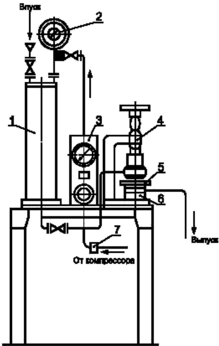
1 — бачок; 2 — образцовый манометр; 3 — редуктор; 4 — зажим; 5 — образец картона; 6 — подкладочная сетка (№ 11); 7 — фильтр для очистки воздуха
