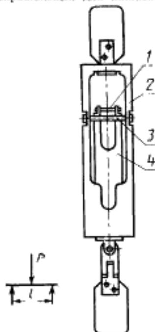
Нижняя деталь состоит из круглого стержня с двумя стойками 4, между которыми укреплен изгибающийся валик 1. Изгибающийся валик, также как и опорные, свободно вращается вокруг своей оси.
