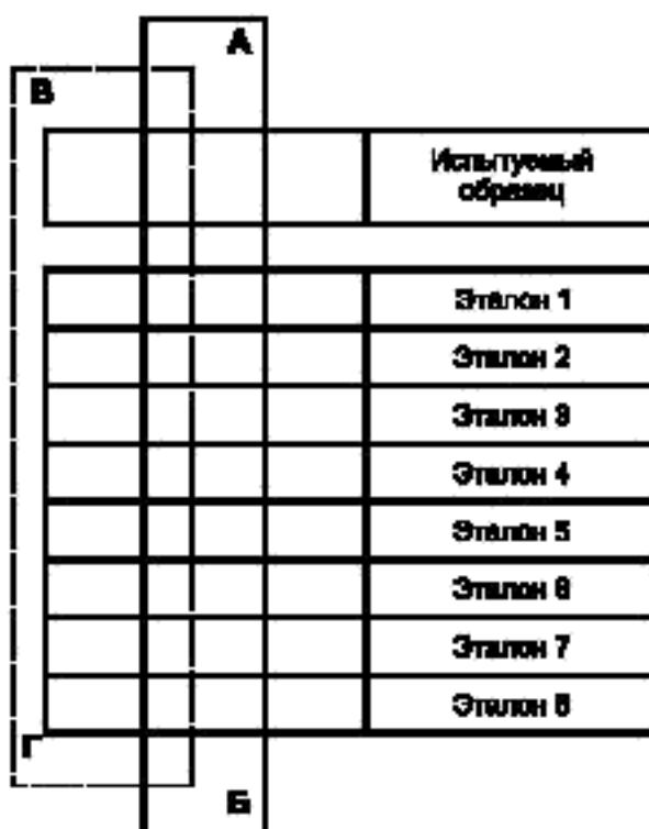
АБ — покрытие, закрывающее среднюю часть образца и синих эталонов; ВГ — второе покрытие
