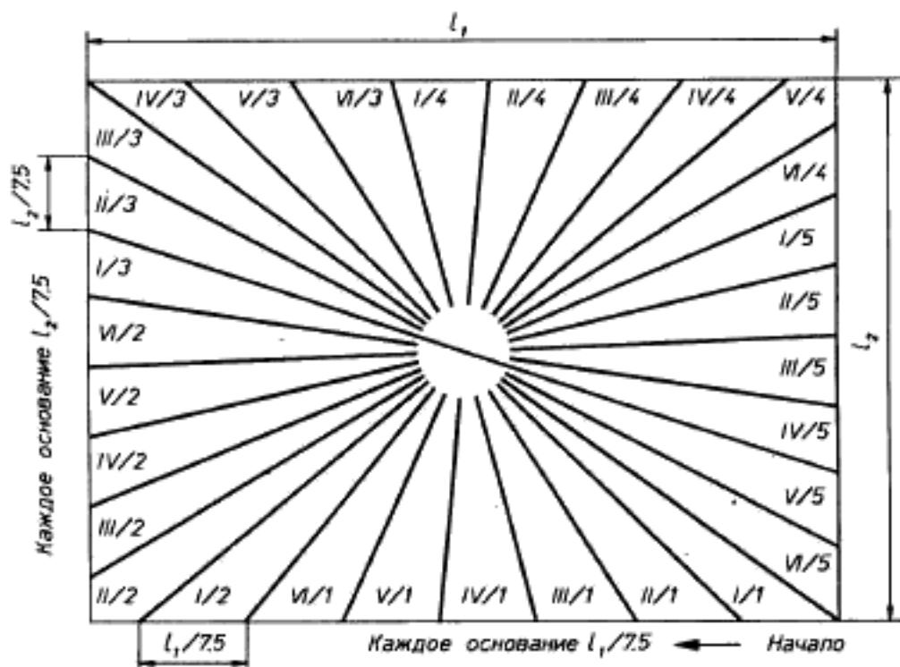
Рисунок 2 — Диаграмма, иллюстрирующая способ нарезания образцов для испытаний с постоянной площадью из пробных листов, отбиравемых в соответствии с диаграммой на рисунке 1
